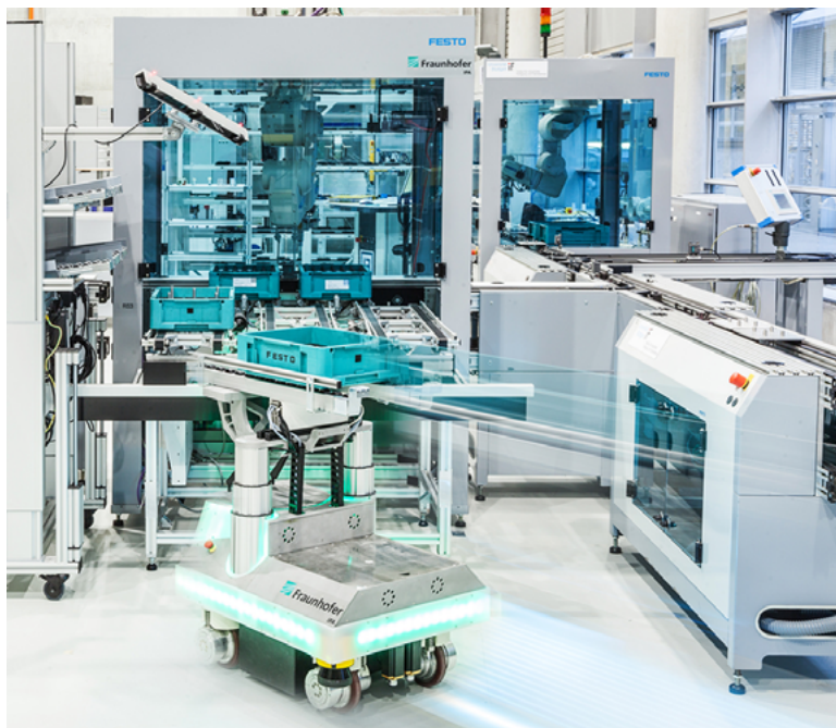
Auch mithilfe externer, an die Cloud angebundener Sensoren können sich fahrerlose Transportfahrzeuge hochgenau lokalisieren. (Quelle: Fraunhofer IPA, Foto: Rainer Bez)
