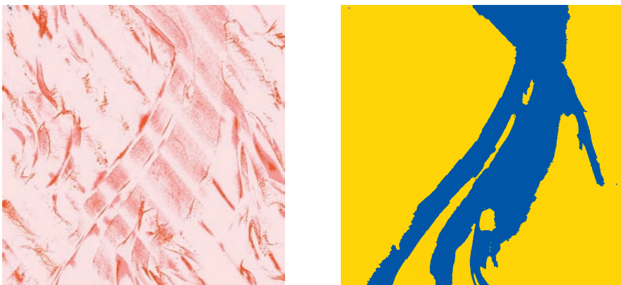
Abb. 22: Befliegung „Außenweser 2005“ – zu klassifizierende Laserpunktswolke intensitätskodiert: hell – geringe Intensität, dunkel – hohe Intensität (links), Ergebnis der Plausibilisierung (rechts): Wasser – blau, Watt – gelb
