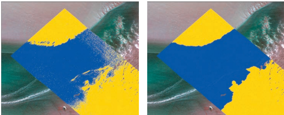
Abb. 16: Befliegung „Friedrichskoog 2005“ – nördlicher Abschnitt des Flugstreifens – Ergebnis der Klassifikation (links) und Ergebnis der Plausibilisierung (rechts). Die gelbe Farbe kennzeichnet Punkte, die als Watt klassifiziert wurden. Die blaue Farbe kennzeichnet Punkte, die als Wasser klassifiziert wurden
