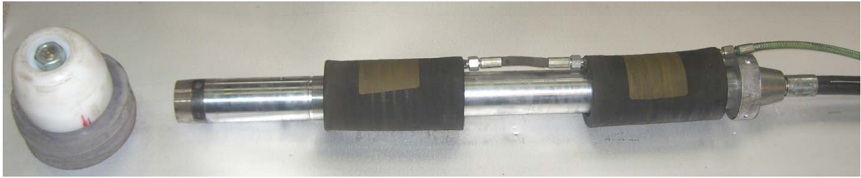
Bild 4: Einzugtechnik, bestehend aus Einziehkopf, Erdrakete und Schubverbindungselement
