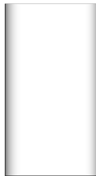
b) Aerogelbetonkern U = 0,22 W/m 2 K; d = 22 cm
