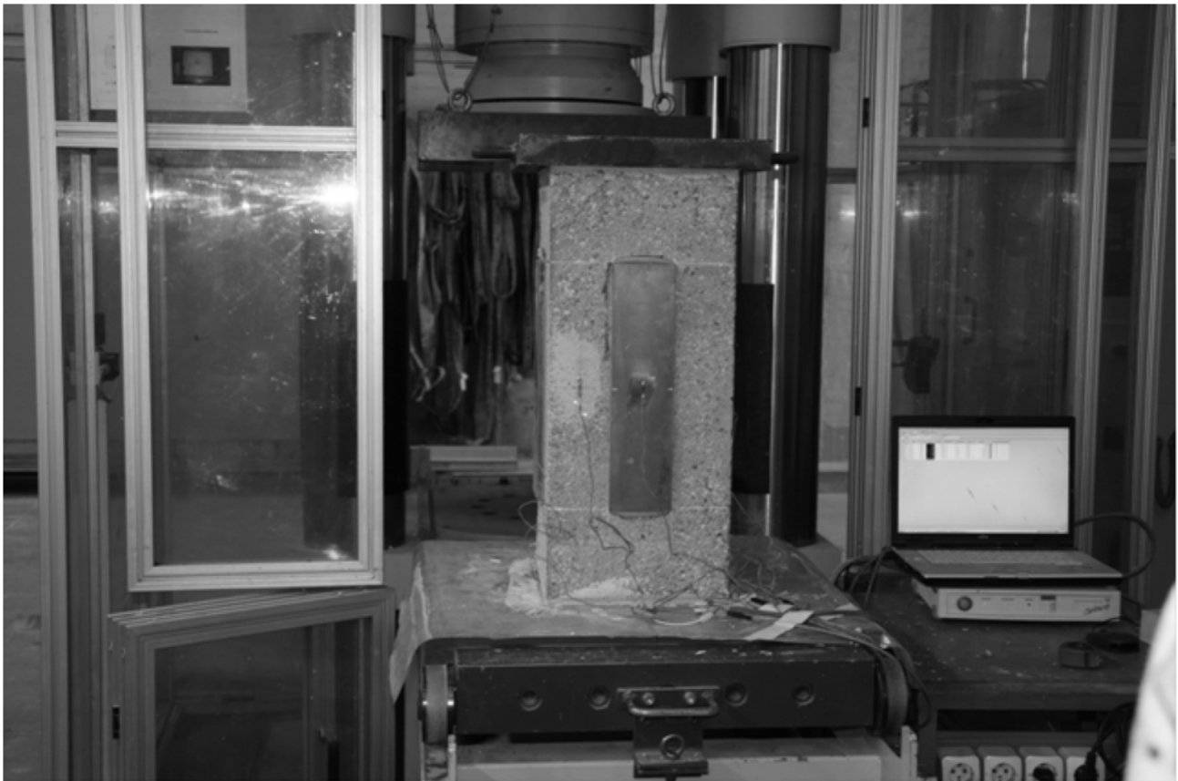
Bild 3.3: Foto des Versuchsaufbaus der Verbunddruckversuche
