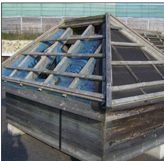
Abb. 20: Ansicht eines L-förmigen Versuchshäuschens, das mit einer V13-Bahn (rechts) und einer gitterverstärkten Folie (links) abgedeckt wurde.
