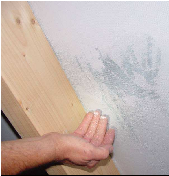
Abb. 41 und 42: Abkreiden der unteren Beschichtung in Feldmitte zwischen den Sparren und am Rand
