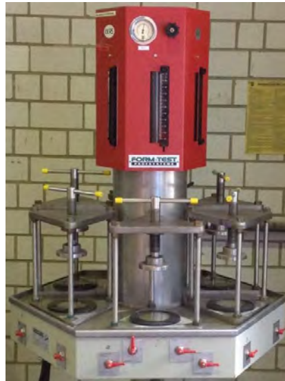
Abbildung 19: Prüfanlage zur Wasser Eindringung (TU Kaiserslautern)
