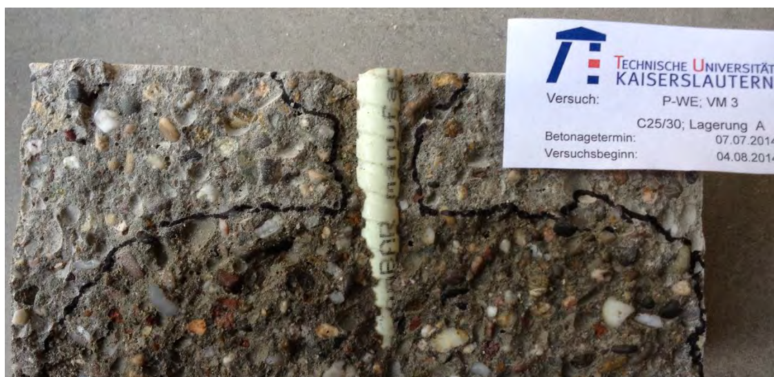
Abbildung 20: P-WE; VM; C25/30; Lagerung A, an Verbindungsmittel komplett durchdrungen
