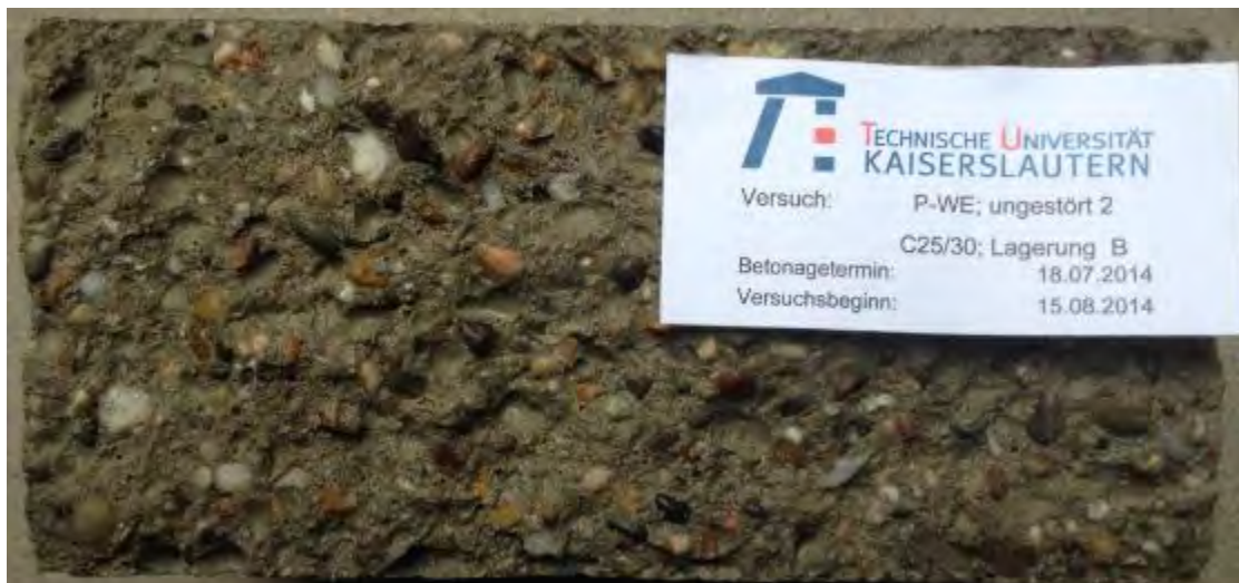
Abbildung 22: P-WE; ungestört; C25/30; Lagerung B, vollständig mit Wasser durchdrungen
