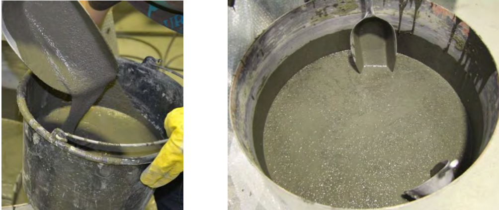
Abbildung 8: Betonmischung: fließfähig, selbstverdichtend und selbstentlüftend
