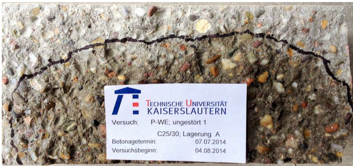
Abbildung 72: P-WE; ungestört 1; C25/30; Lagerung A
