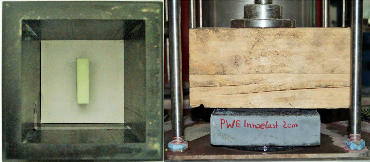
Abbildung 49: Schalung für Versuchskörper „PWE InnoElast 2 cm (links); im Versuchsstand (rechts)
