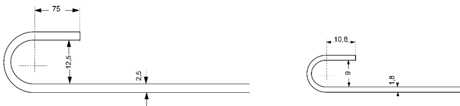
Bild 2.2: Warm gebogene Rundhaken nach Considere aus DAfStb 14
