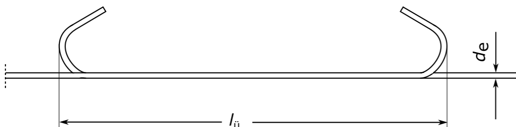
Bild A1.3: Übergreifungsstoß nach DIN 1045 1972 mit spitzwinkligem Haken
