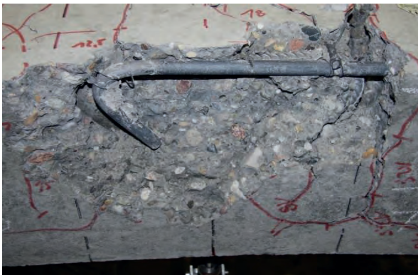
Bild 3.6: Versagen des Übergreifungsstoßes mit Hakenauszug (Balken R7)
