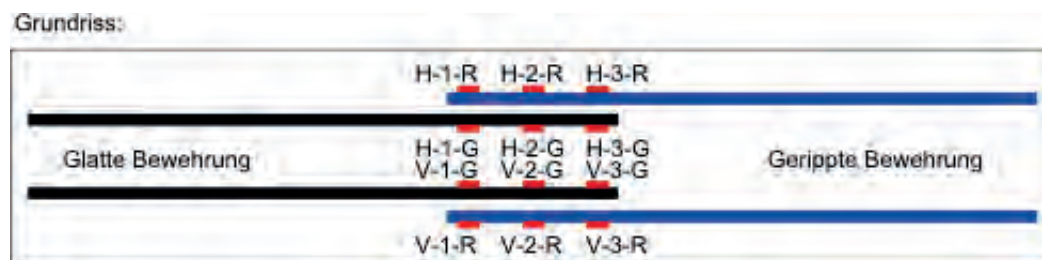
Bild 3.20: Bezeichnung der Dehnungsmessstreifen
