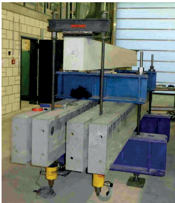
Bild 4.6: Versuchsstand: Seitenansicht und Auflagerdetails
