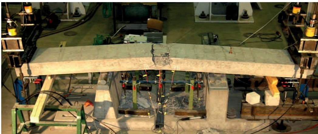
Bild 3.4: Versuchstand mit Probekörper nach Versuchsende (Balken R7)
