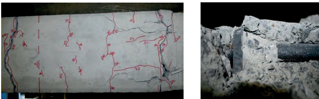
Bild 4.28: Stoßversagen bei aufgeschweißter Ankerplatte (Grundriss + Detail Seitenansicht)
