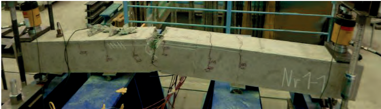
Bild 3.17: Versuchstand mit Probekörper am Versuchsende (Balken E1-1)
