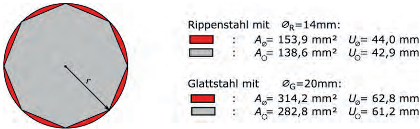
Bild 5.8: Querschnittsflächen der im Modell verwendeten Glatt- und Rippenstähle
