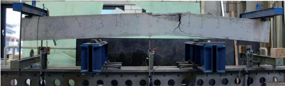
Bild 4.8: Versuchsstand nach dem Versagen
