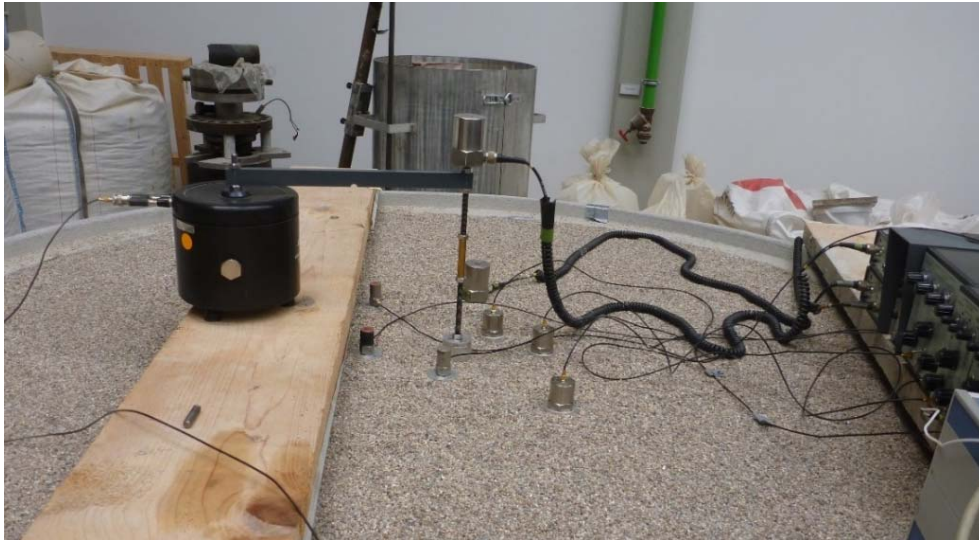
Abbildung 8: Versuchsaufbau im Labor mit eingebetteten Modellpfählen
