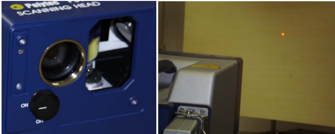
Abbildung 44: Messprinzip Laser-Doppler-Vibrometer; Messstrahl mit Laser-Messpunkt auf einer Oberfläche
