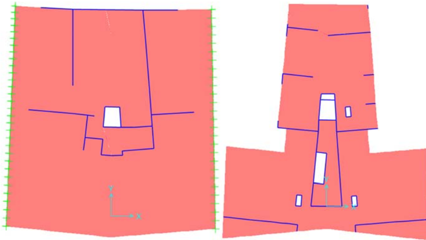
Abbildung 22: Systemgrundrisse der Bodenplatte sowie einer Obergeschosdecke
