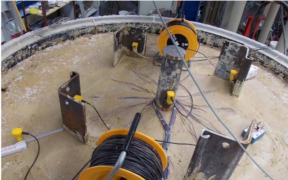
Abbildung 14: Versuchsaufbau im Labor mit eingebetteten Spundwandprofilen
