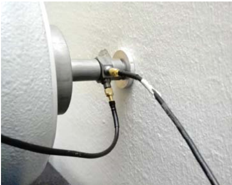
Abbildung 60: Körperschallanregung der Gebäudestruktur mit einem elektrodynamischen Shaker; Messung der Leistungseinleitung am Impedanzmesskopf
