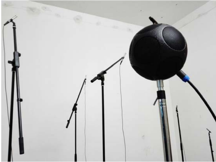
Abbildung 47: Messung des Schalldruckpegels im Senderaum mit Mikrofonen; Luftschallquelle
