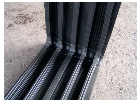
Abb. 3: Falsche und richtige Eckausführung bei außenliegenden Fugenbändern; a) Verwerfungen der Sperranker bei Verlegung mit zu kleinem Radius, b) im Herstellerwerk gefertigte Ecke
