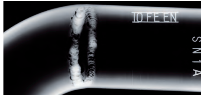
Rundnaht DN50, verschweißt mit falschem Schweißzusatzwerkstoff.
