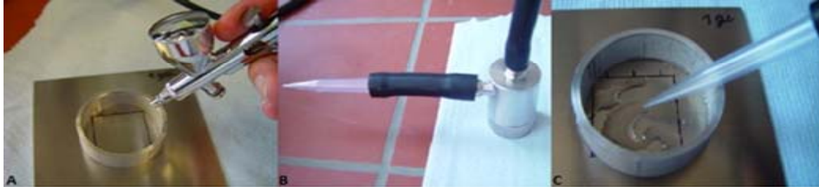
Abbildung 5: A: Ablösung der Verschmutzung; B: Aufbau Zyklon-Einheit; C: Aufnahme der abgelösten Verschmutzung
