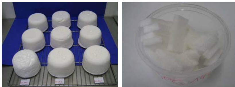
Abbildung 15: Aufgeschlagene Gelatineschäume vor dem Trocknungsprozess (links) Geschnittene Gelatineschaumpads (rechts)
