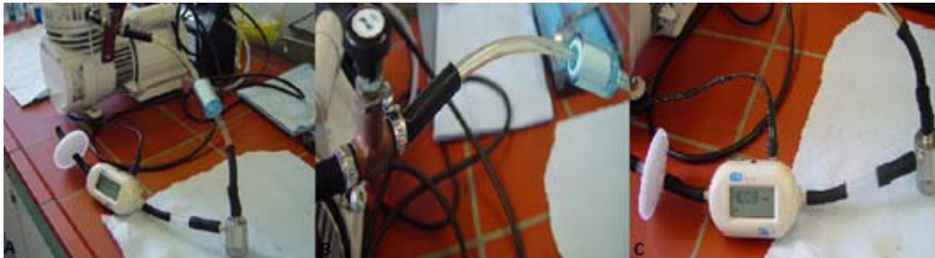
Abbildung 6: Funktionsprinzip Zyklon: A: Versuchsaufbau für die Volumenstrom-Einstellung B: Regelventil und Partikelfilter C: Durchflussmessgerät TSI 4100
