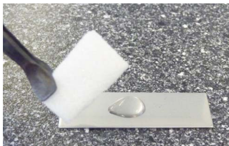
Abbildung 57: Mit Mikroorganismensuspension angeschmutzte, glatte Edelstahloberfläche. Die Beprobung erfolgte mit einem Gelatineschaumpad-Stückchen (1 x 1 cm).
