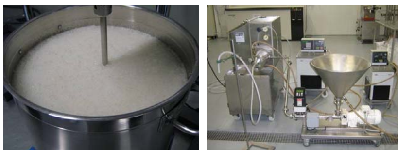
Abbildung 14: Gelatineverarbeitung: Erwärmen einer Gelatinelösung unter Rühren (links), Schaumgenerator von Hansa-Mixer (rechts)
