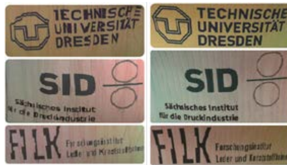
Abbildung 2 Vergleich der optischen Qualität ohne (links) und mit (rechts) Anpassung des Oberflächensichtsystems an den Tiefziehprozess und der Berücksichtigung der Materialdehnung sowie des Faltenbildungsprozesses
