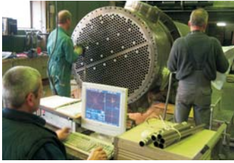
Wirbelstromprüfung von Heizflächenrohren
