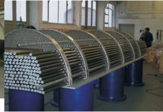
Schweiß / Prüfaufsicht, QS / QM Tätigkeiten bei der Fertigung von Duplex und TF Kühlern für ein Kernkraftwerk. Spezifikation IS 1801
