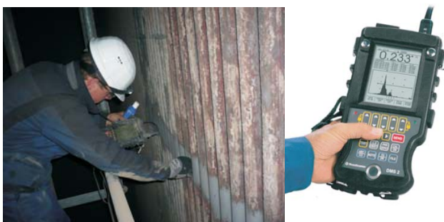
Wanddickenmessung bei Revisionsarbeiten im Kessel eines MKW.
