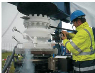
Prüfaufsicht beim Probelauf des Drehgelenks eines Schiffsverladearms für Flüssiggas. Druck- und Dichtheitsprüfung unter Kryogenen Bedingungen.
