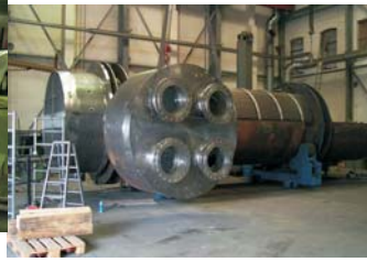
Schweiß / Prüfaufsicht, QS / QM Tätigkeiten bei der Fertigung von Duplex und TF Kühlern für ein Kernkraftwerk. Spezifikation IS 1801
