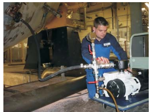
Mit unserer Turbo Molekular Pumpe sind wir in der Lage auch größere Volumen zu evakuieren.
