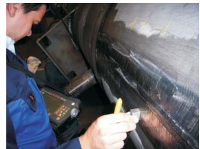
Manuelle Schweißnahtprüfung mit einem digitalen Ultraschallgerät USN58L
