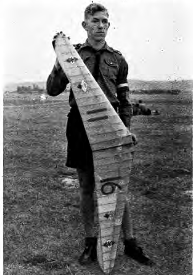
Abb. 7. Nurflügel, der sich besonders gut hochstarten läßt
