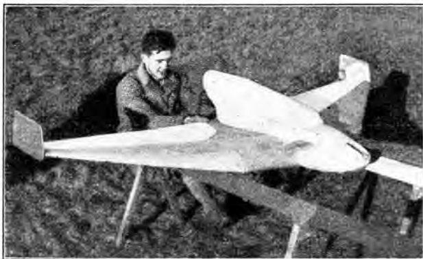
Abb. 4. Schwanzloses Flugmodell mit Kopfsteuer (1932), festgehalten von Heini Dittmar, wird katapultiert
