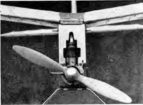
Abb. 15. Benzinmotor in einer Blechverkleidung des Rumpfkopfes
