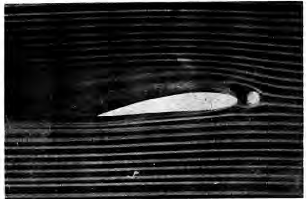
Abb. 7. Dicker Turbulenzdraht vor einem Flugmodell-Tragflügelprofil
