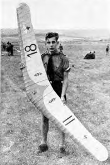
Abb. 8. Ein Nurflügel, der dem Nurflügel-Segelflugzeug „Horten IV“ nachgebildet ist
