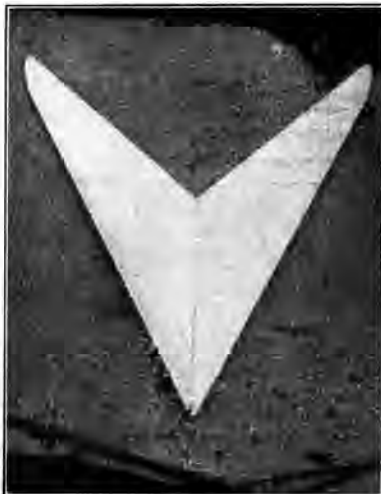
Abb. 12. Neuer Modellentwurf der Gebr. Horten mit ungewöhnlich starker Pfeilform
