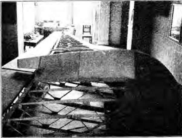
Abb. 8. Zusammenbau des Tragflügels von 12 m Spannweite der „Horten I“ 1933 in der elterlichen Wohnung
