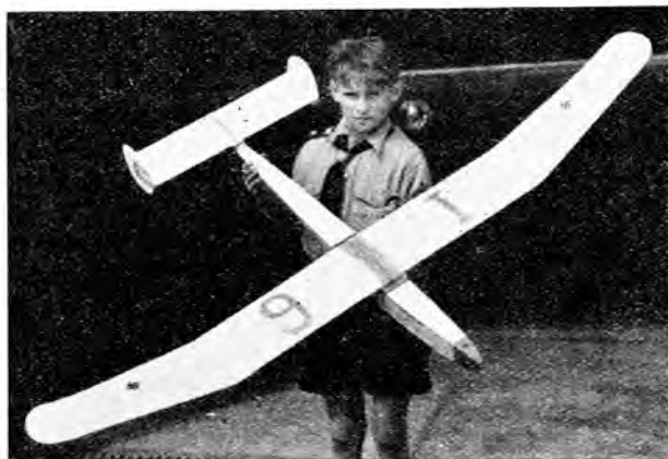
Abb. 3. Flugmodell mit ausklinkbarem Tragflügel und abnehmbarem Leitwerk
