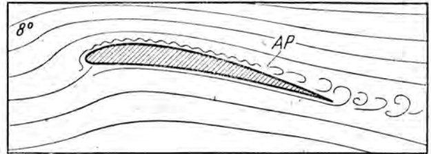
Bild V. Der Ablösungspunkt A P liegt wegen der größeren Profildicke bzw. der etwas stärkeren Krümmung der Flügeloberseite weiter von der Flügelhinterkante entfernt als beim dünneren Profil G 417 a (vgl. Bild R)
