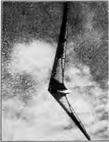
Abb. 11. Hochleistungs-Segelflugzeug „Horten IV“, Gleitverhältnis 1 : 37!
