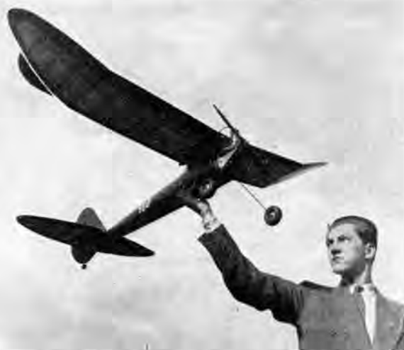
Abb. 7. Schnittiges schwedisches Benzinmotor-Flugmodell, das mit einem „G. P.“-Motor ausgerüstet ist
