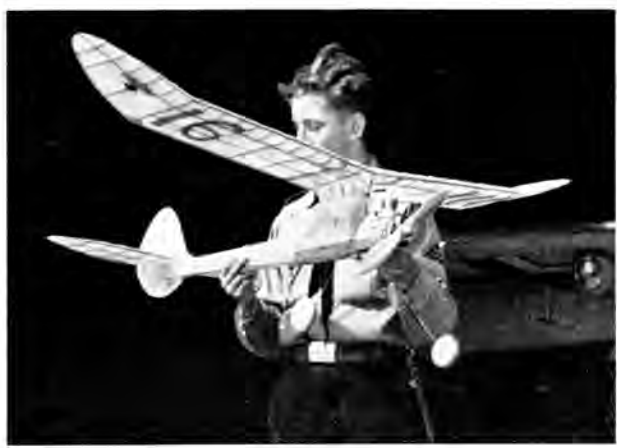
Abb. 13. Benzinmotor-Flugmodell mit Baldachin-Tragflügel
