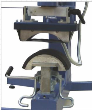
Die Kappen Option der TS 5P ist so aufgebaut, dass Sie auch für tief geschnittene Kappen gut funktioniert. Durch die Spannvorrichtung können die Kappen optimal zum Drucken gehalten und gespannt werden. Die Kappen-Vorrichtung für die TS 5P besteht aus einem Druckkopf und einer Spannvorrichtung.
