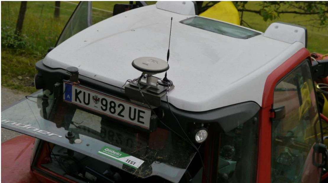
Abbildung 5: GPS- und RTK – Antenne am Traktordach
