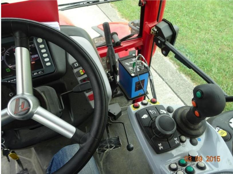
Abbildung 3: Messsystem zur Erfassung der Fahrdynamik „ADMA“ Fa. Genesys
