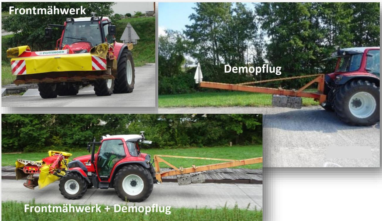
Abbildung 28: Fahrten mit verschiedenen Ballastierungen über die Testbahnen
