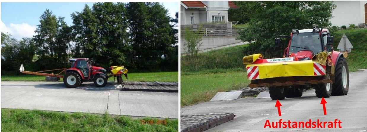
Abbildung 24: Auffahrt auf die Testbahn (100m) mit Ballastierung vorne und hinten
