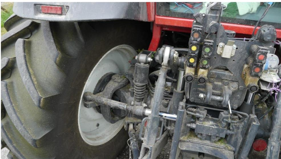
Abbildung 15: Hinterradlenkung beim Versuchsfahrzeug
