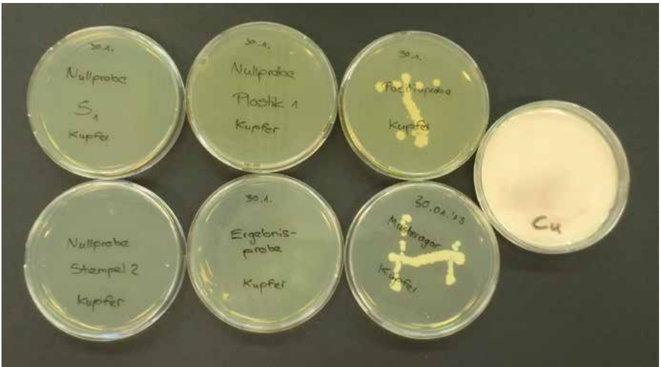
Abb. 9: Versuchsreihe mit Kupferionen: Obere Reihe: Nullprobe für Stempel 1, Nullprobe für den Kunststoff, Positivprobe; Untere Reihe: Nullprobe für Stempel 2, Ergebnisprobe, Musteragar; Rechts daneben: Kupfersulfat-Kunststoffprobe.
