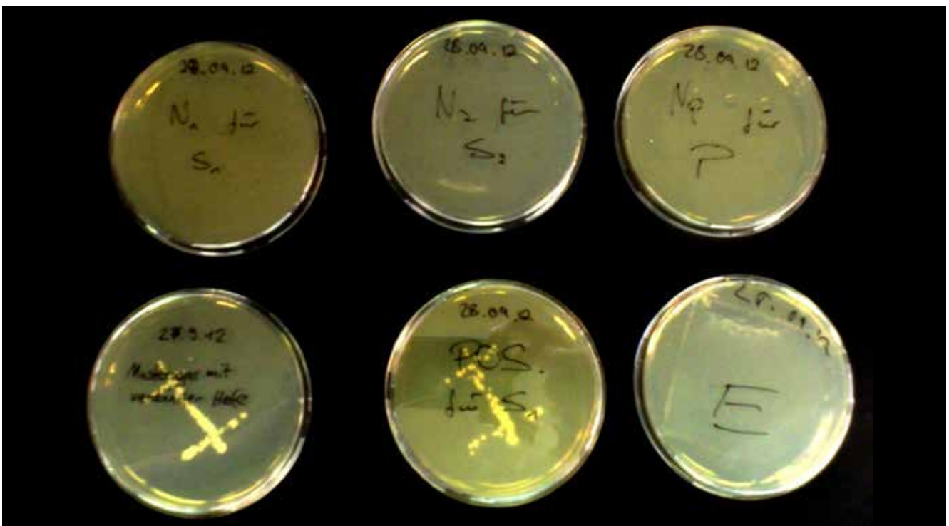
Abb. 10: Versuchsreihe mit allen Wirkstoffen: Obere Reihe: Nullproben für Stempel 1, für Stempel 2 und für den Kunststoff; Untere Reihe: Musteragar, Positivprobe, Ergebnisprobe.
