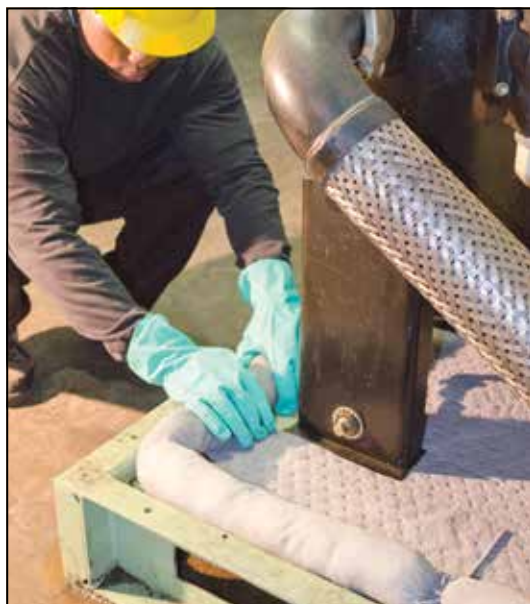
Saugsocken können auf einfache Weise um Maschinenkanten geformt werden und absorbieren Öle und Überspritzungen.
