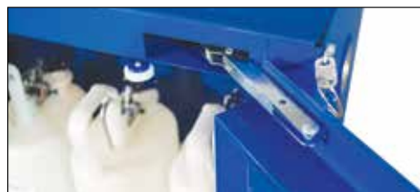
Eingekapselter, selbstschließender Mechanismus ermöglicht den ungehinderten Zugriff auf das obere Regal. Schmelzlot schmilzt im Brandfall bei 74 °C und schließt automatisch die Tür(en).
