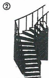
Treppe mit 90° Wendepunkt
