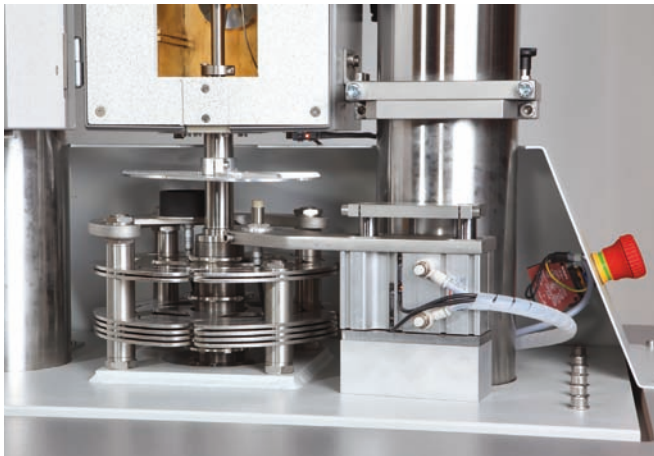
Bei der Messkonfiguration mit Temperierkammer und zwei dynamischen Wegaufnehmern entfernt ein pneumatischer Liftmechanismus den nicht benötigten Sensor aus dem Messbereich.
