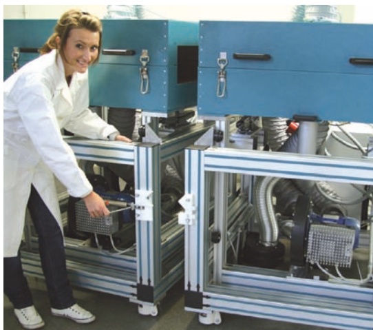
Nach dem Baukastensystem werden die einzelnen Elemente der Beschichtungsanlage zusammengefügt.
