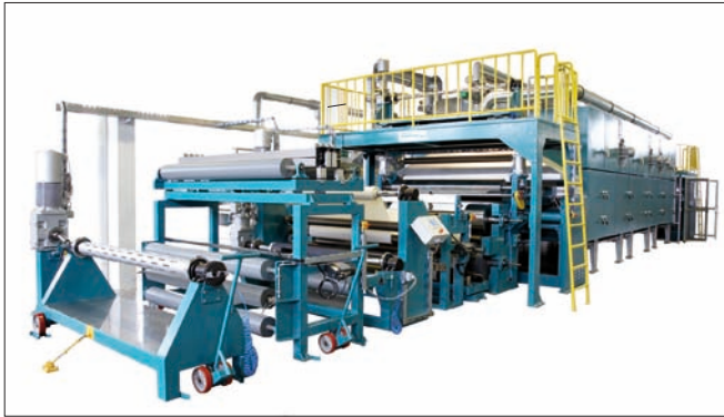
Auf der universellen Produktionsanlage sind Zugspannungen von 25 bis 5 000 N realisierbar.
