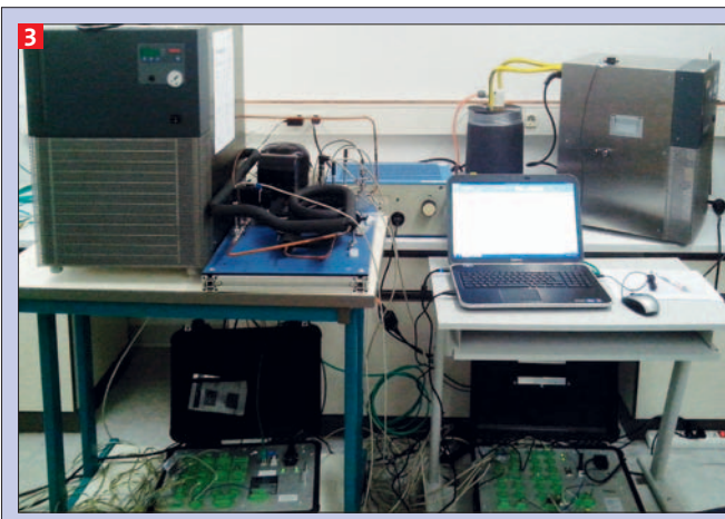
3 Versuchsaufbauten und Messplatz für Vergleichsmessungen (links R-744 Umlaufkühler, rechts R-507-Umlaufkühler mit externem Temperiergefäß verbunden)
