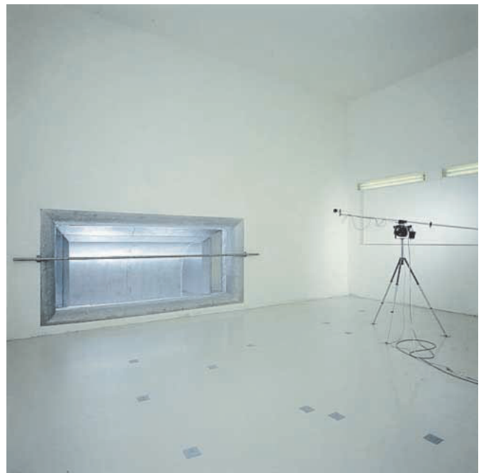
Bilder 2 + 3: Lindab Akustiklabor – Messung von Kanalschalldämpfern nach ISO 7235 links – Messstrecke rechts – Hallraum
