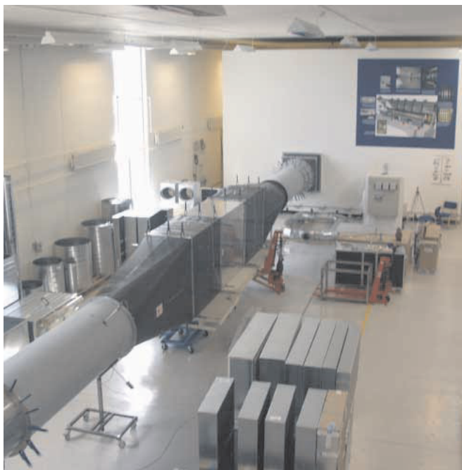
Bilder 2 + 3: Lindab Akustiklabor – Messung von Kanalschalldämpfern nach ISO 7235 links – Messstrecke rechts – Hallraum
