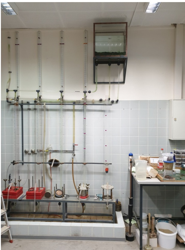
Abbildung 7-2: Bestimmung des Durchlässigkeitsbeiwertes im geotechnischen Labor
