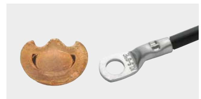
Bild 18: Kerbpressung (Doppeldorn) Schliffbild und verpresster Kabelschuh
