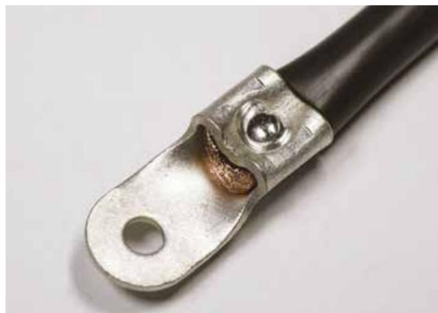
Bild 14: Quetschkabelschuh mit Dornpresseinsatz Q22 verpresst
