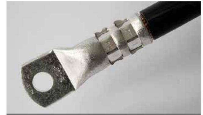
Bild 22: Presskabelschuh nach DIN falsch verpresst (Überpressung)
