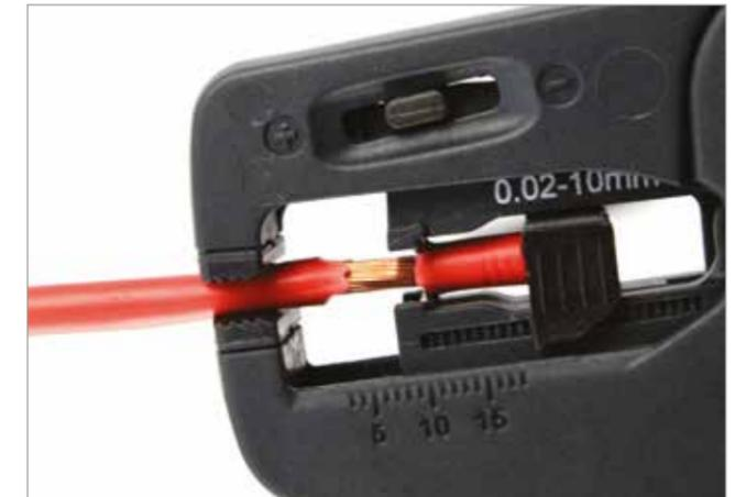
Bild 8: Parallele Abisoliermesser führen bei zähen Isolationsmaterialien zu unsauberen Abisoliererergebnissen
