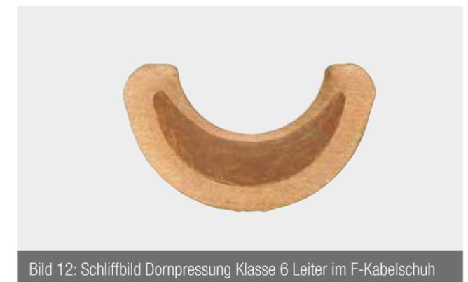
Bild 12: Schliffbild Dornpressung Klasse 6 Leiter im F-Kabelschuh
