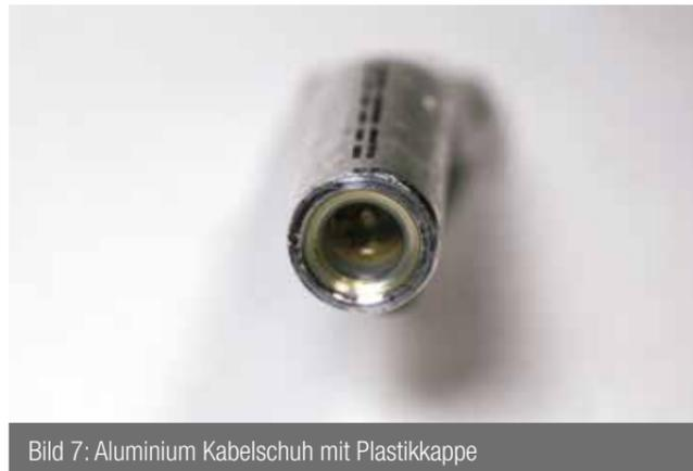
Bild 7: Aluminium Kabelschuh mit Plastikcappe
