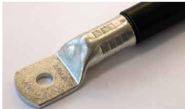
Bild 21: Rohr Kabelschuh falsch verpresst (Unterpressung)
