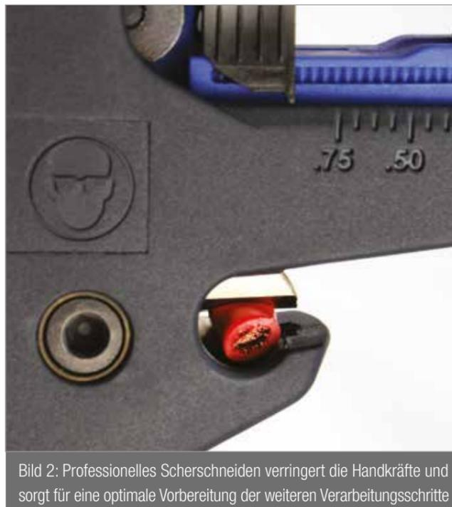
Bild 2: Professionelles Scherschneiden verringert die Handkräfte und sorgt für eine optimale Vorbereitung der weiteren Verarbeitungsschritte
