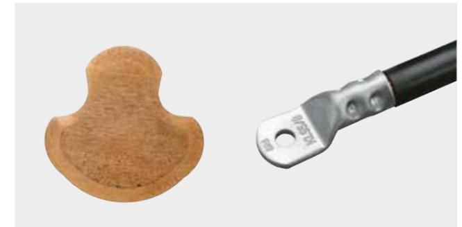
Bild 16: Schliffbild Kerbpressung und verpresster Kabelschuh
