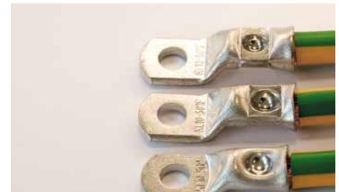
Bild 24: F-Kabelschuh mit Dornverpressung, Vorderseite. Überpressung, richtige Verpressung, Unterpressung (v.o.)
