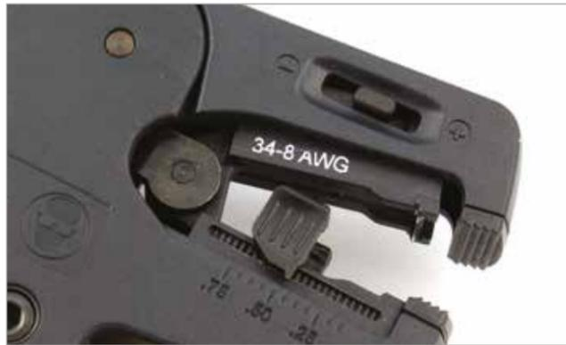
Bild 5: Zoll-Bemaßung für AWG-Kabeltypen (American Wire Gauge)
