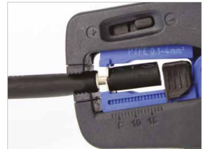
Bild 9: Isolationen werden mit der K43/2V rundherum eingeschnitten und verringern so die Abzugskräfte.
