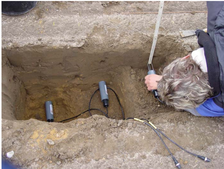
Abbildung 2.4. Installation der ML2x-Sonden am 12.5.2005.
