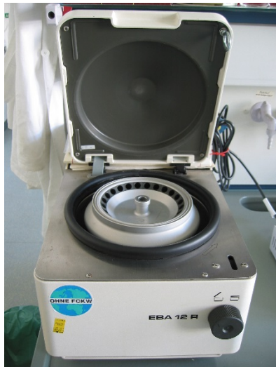
Technisches Gerät Es kann 6000 Umrundungen In der Minute machen.
