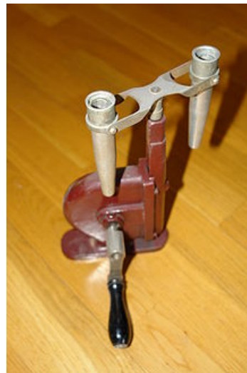
Handbetriebenes Gerät Kann 3000 Umdrehungen In der Minute machen
