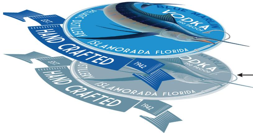
Die Weiß Dry Ink wird in jenen Bereichen rückseitig auf den transparenten Bedruckstoff gedruckt, an denen sich ein Bildobjekt befindet.
