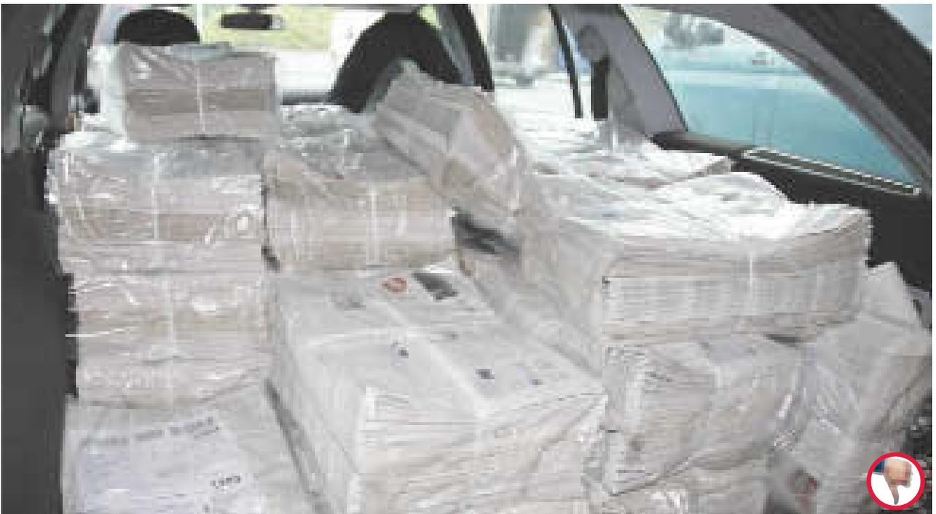
Nach vorne ist kein Formschluss gegeben, weil das vorhandene Trennnetz nicht benutzt wurde. Bei einer Gefahrenbremsung würden die oberen Zeitungspakete den Fahrer gefährden.
