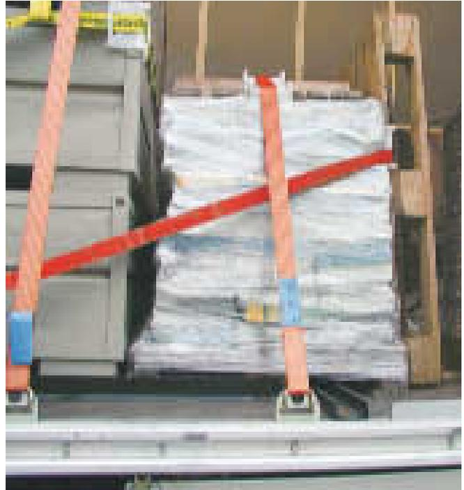
Vorteil der Zurrchiene: Mit festem Zurrpunktabstand von 1,2 m wäre diese kombinierte Ladungssicherung nicht möglich gewesen.
