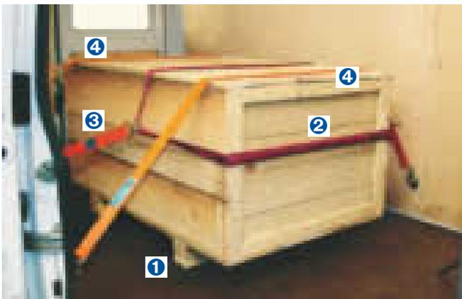
Diese Ladung wurde durch Niederzurren (Kraftschluss) und zusätzlich nach vorn durch eine Kopfschlinge (Formschluss) gesichert.
