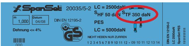
Zur Sicherung ist eine Gesamtvorspannkraft von mindestens 255 daN erforderlich. Rechnerisch wäre ein Zurrmittel mit einer  $S_{TF}$  von 350 daN erforderlich (laut Kennzeichnungsetikett). Um ein Verdrehen der Bücherpalette während des Transports zu verhindern, sind zwei Zurrmittel einzusetzen.
