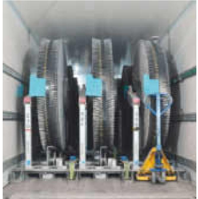
unten: Manuelle Verzurrung der Spezial-Disc-Träger auf der Ladefläche
