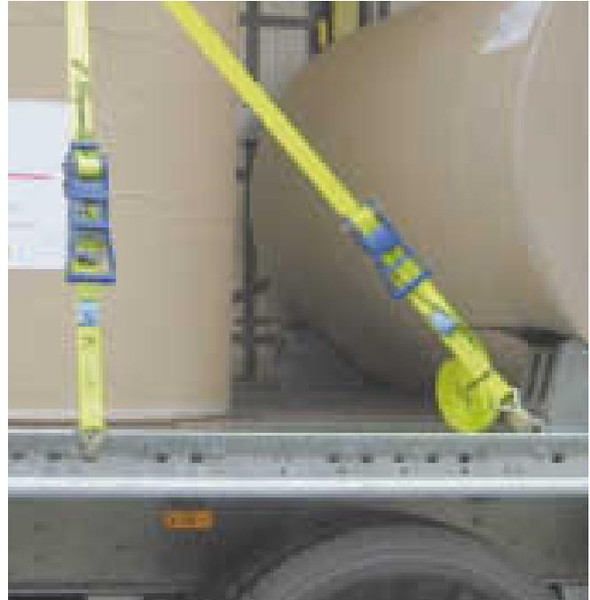
Zurrpunkt gemäß DIN EN 12640: Befestigungsvorrichtung am Fahrzeug, an der ein Zurrmittel direkt befestigt werden kann
