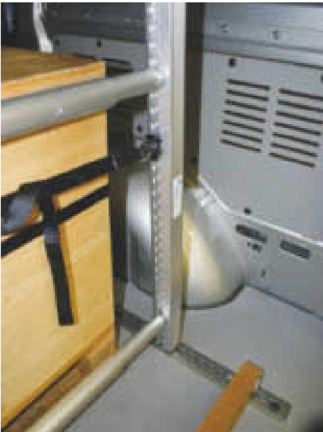
Lochschiene mit Vorrichtung für Sperrstangen
