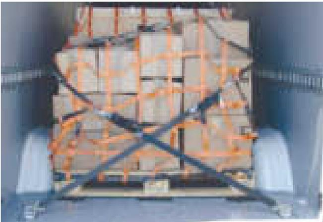
Zurnetz für Transporter, bestehend aus Netz, Schnellspannurten und Vario-Teleskopstange. Das Netz kann für leichtes Ladegut auch als Laderaumtrennung eingesetzt werden. Durch ein Erweiterungsnetz ist es verlängerbar.
