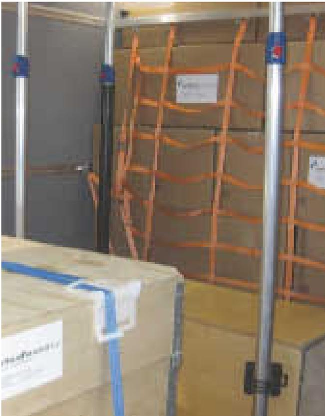
Blockieren mit Hilfe von Sperrstangen
