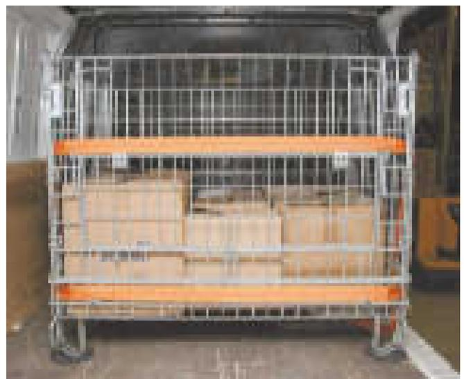
Ladungssicherung durch verzurte Gitterbox auf Anti-Rutsch-Matten. Die Gurte wurden durch das Gitter gezogen und können so nicht nach unten rutschen.
