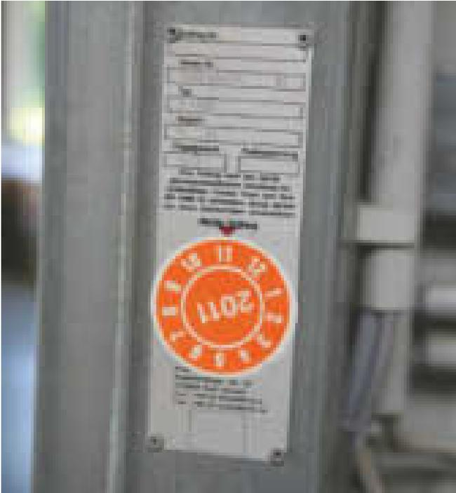
Prüfsiegel an einem elektrischen Rolltor
