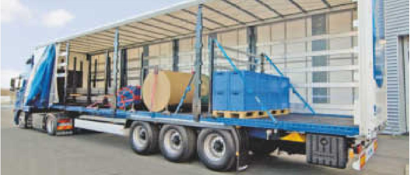
Diese Fahrzeugaufbauten, hier besonders die Seiten und die Dachkonstruktionen, sind in der Lage, die Kräfte, die von einer formschlüssig verladenen Ladung z.B. bei einer starken Kurvenfahrt eingeleitet werden, aufzunehmen.
