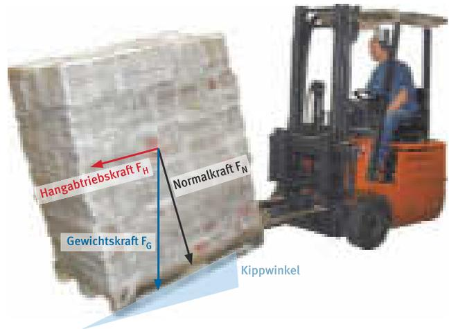
Die untersuchten Paletten wurden mit  $12\text{ kg}$  schweren, folierten und umreiften Zeitungspaketen nach einem festgelegten Packschema beladen.
