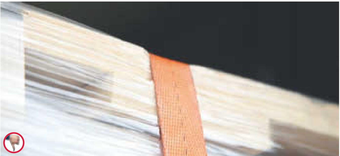
Ohne Kantenschutz: Die Kopfpalette wird eingedrückt, daher ist keine gleichmäßige Vorspannkraftverteilung im Zurrgurt möglich. Zudem kann der Zurrgurt, in diesem Beispiel durch einen Palettennagel, beschädigt werden.
