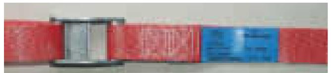
Das Gurtband wird durch das Klemmschloss gezogen, mit der Hand gespannt und durch die Gurtbandklemme fixiert. Die zulässige Zurrkraft (LC) des Systems variiert je nach Gurtart zwischen 250 daN und 1.000 daN im geraden Zug. Die erreichbare Vorspannkraft, die über das Klemmschloss aufgebracht werden kann, ist nur sehr gering.
