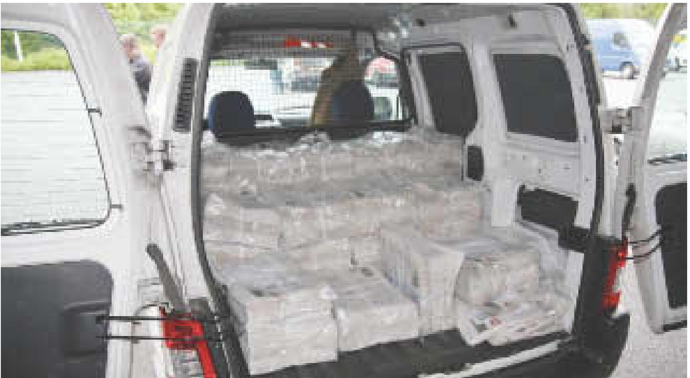
Das Fahrzeug hat zum Schutz des Fahrers ein Trenngitter. Die Zeitungspakete sind formschlüssig auf der Ladefläche verteilt.
