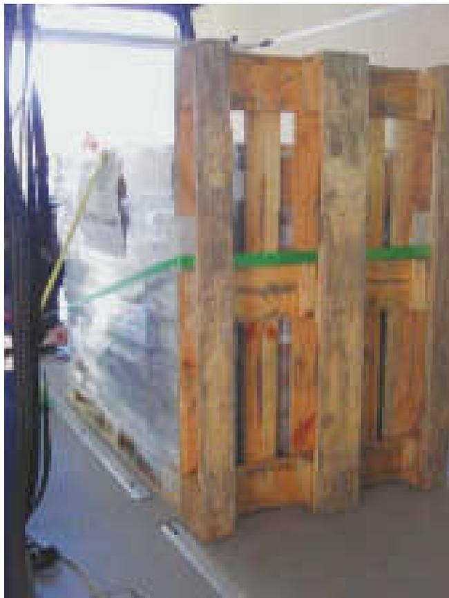
oben: Sicherung nach vorne durch Kopfschlinge mittels Zurrkord und Palette
