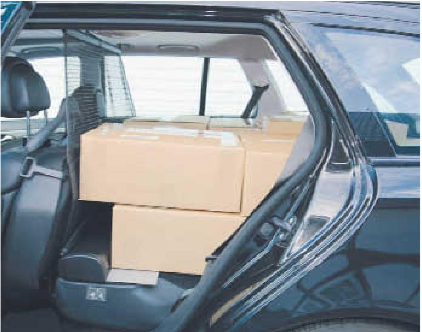
Die Kräfte in Fahrtrichtung werden durch die umgeklappte Rücksitzbank und das Trennnetz aufgenommen; zu den Seiten durch die Karosserie und nach hinten durch die Heckklappe. In diesem Beispiel ist der Formschluss nach hinten nur bedingt möglich, daher sollte die Ladelücke bis zur Heckklappe ausgefüllt oder rutschhemmendes Material eingesetzt werden.
