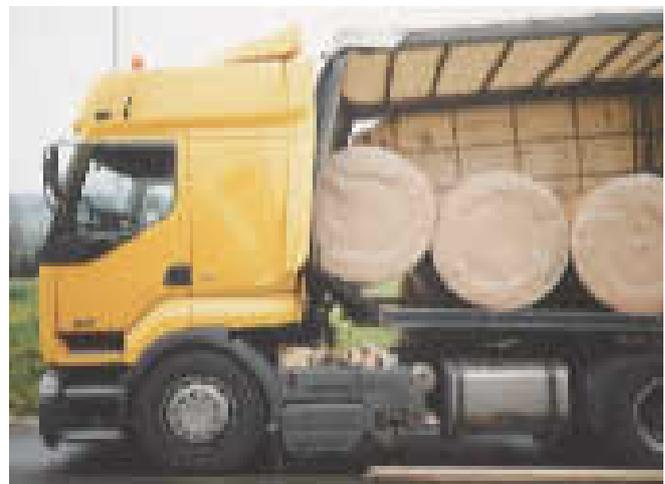
Eine ungesicherte Ladung wird beim Fahren ins Rutschen, Rollen oder ins Kippen geraten, wenn die Massenkraft größer wird als die Reibungskraft.
