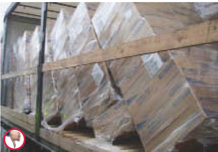
80 % des Ladungsgewichts wirken bei einer Gefahrenbremsung nach vorne.
