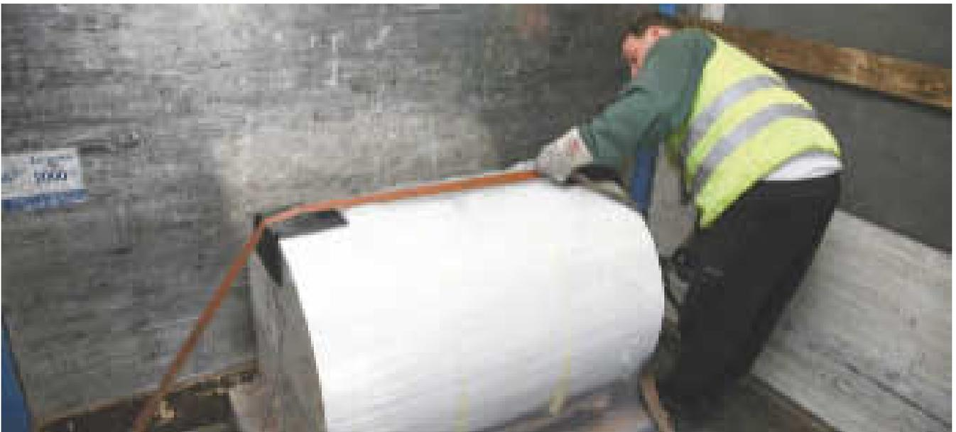
rechts: Da zwischen den Rollen kein Formschluss besteht, muss jede Rollenreihe niedergezurrt werden.
