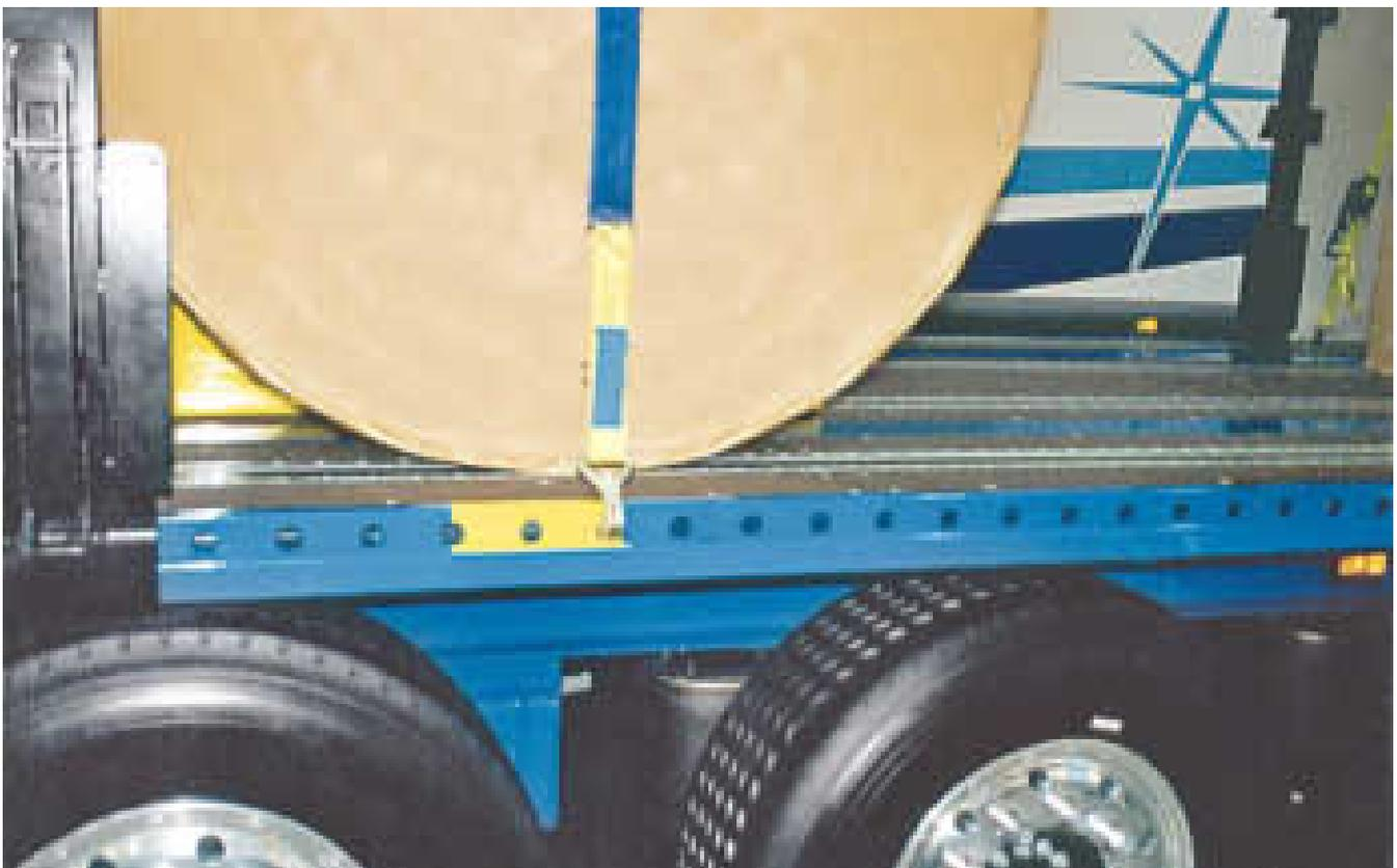
Durch dieses variable Zurrpunktsystem können schwere Einzellasten entsprechend dem Lastverteilungsplan punktgenau platziert und gesichert werden.
