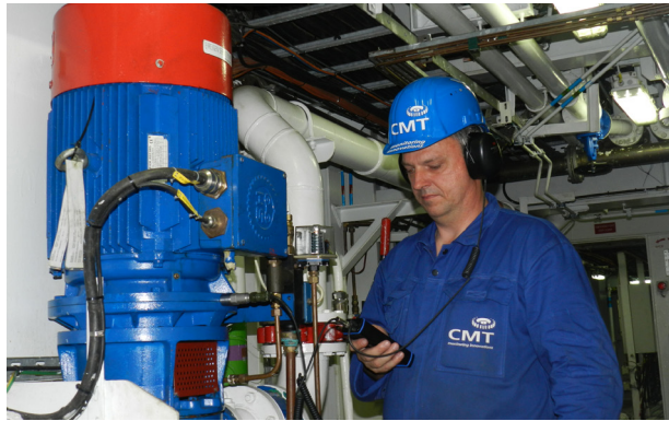
Foto 2: Mit dem Vibration Meter frühzeitig Schäden erkennen
