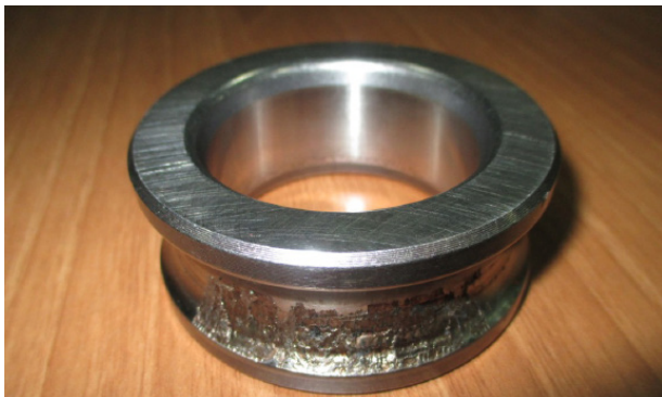
Foto 1: Schaden am Innenring eines oberen Lagers
