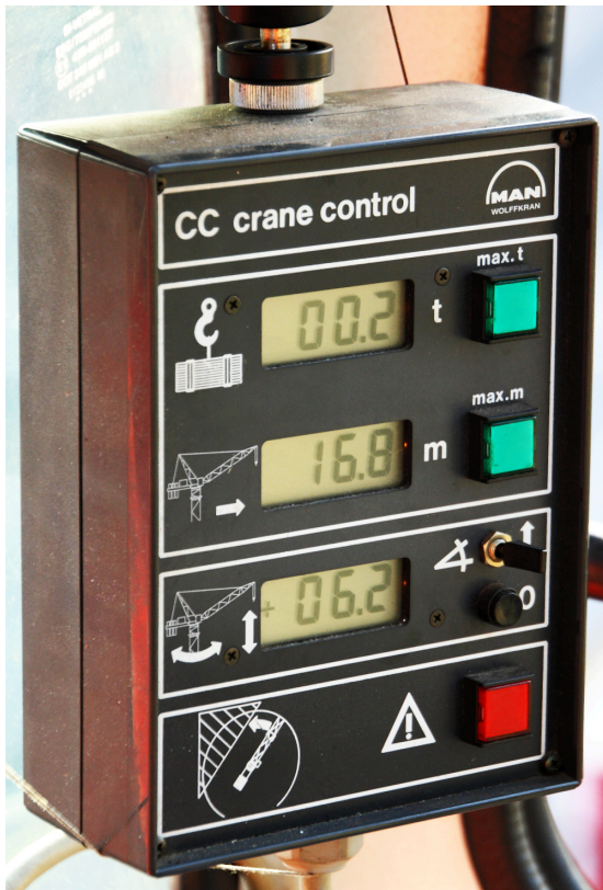
CC 90 Anzeige aus der Zeit der Zusammenarbeit von MAN und Wolff. Ganz unten leuchtet eine kleine Lampe bei der Problematik Schwenkbegrenzungen. (Foto Andreas Wienkötter)
