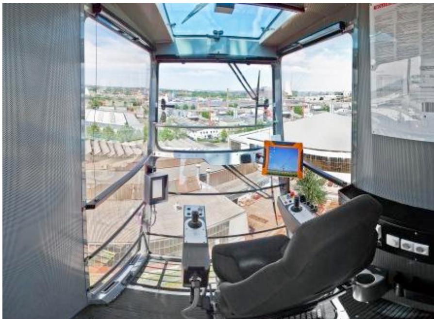
Die aktuelle Wolff Kabine. Links ist die berührungsempfindliche Anzeige. Der als Zubehör erhältliche Bildschirm rechts zeigt die Betriebsanleitung elektronisch an. Auch kann er beim Einsatz von einer Aussenkamera als Anzeigegerät genutzt werden. (Foto Wolff, Archiv A. Bruderer)
