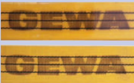
Verschlossene Oberfläche durch die **GEWAPRO**-Verschleißschutz-Imprägnierung.
