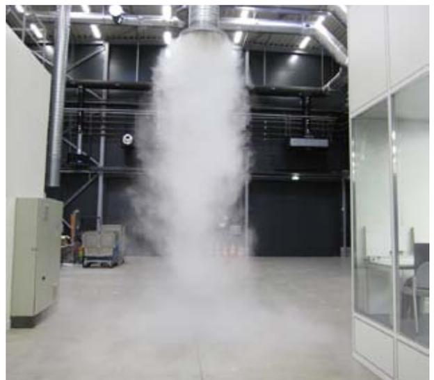
**Bild 6:** Vertikales Ausblasen aus großer Höhe, Strahlausbreitung durch Rauchprobe sichtbar gemacht
