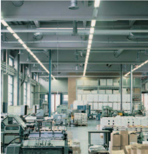
Bild 7: Radialer Verdrängungsauslass in einer Druckerei
