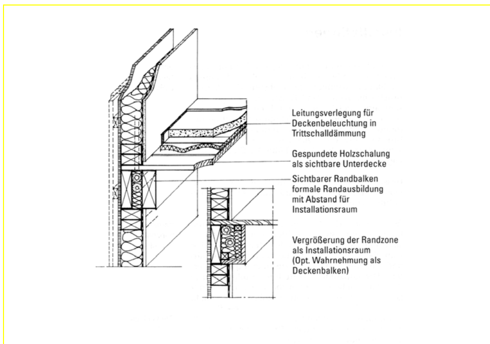
Abb. 8.2-17: Möglichkeiten der Leitungsverlegung im Deckenbereich (Galiläa, 1998)
