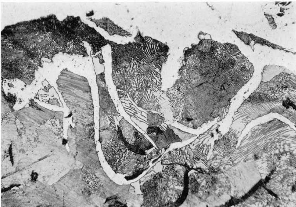
Bild 3 Schliffbild der Verbindungszone Grauguß/Weißmetall. Das Weißmetall ist in die entgraphitierte GG-Oberfläche eingedrungen. Vergrößerung 500mal.
