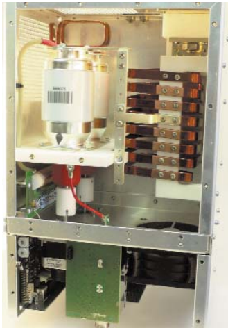
Gehäuseaufbau mit HF-Trennung
