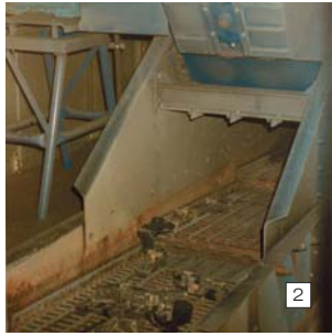
1 Linearschwingensieb für Sinterabsiebung Linear vibratory screen for sinter
