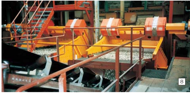
8 Eindeck-Linearschwingensiebe in der Sand- und Kiesindustrie Single-deck vibratory screen for sand and gravel
