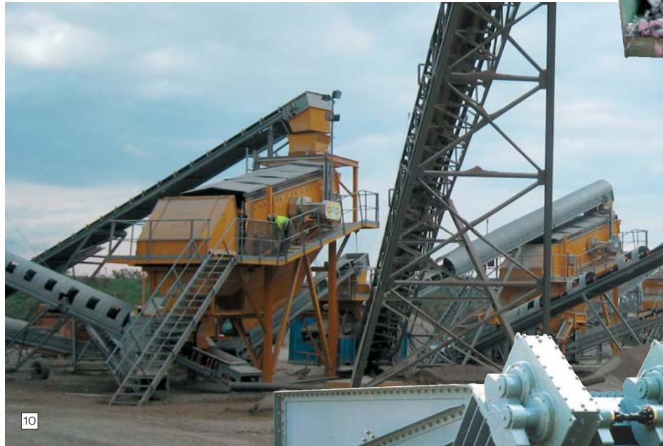
8 Eindeck-Linearschwingensiebe in der Sand- und Kiesindustrie Single-deck vibratory screen for sand and gravel
