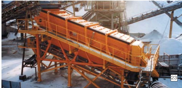
23 Doppeldeck-Spannwellsensieb für verstopfungsfreies Sieben Double-deck Flip-flop screening machine for choke freescreening
