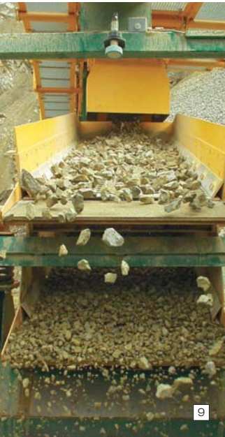
8 Eindeck-Linearschwingensiebe in der Sand- und Kiesindustrie Single-deck vibratory screen for sand and gravel
