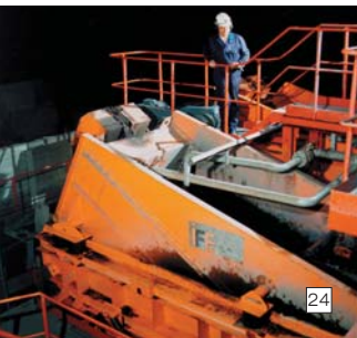
23 Doppeldeck-Spannwellsensieb für verstopfungsfreies Sieben Double-deck Flip-flop screening machine for choke freescreening
