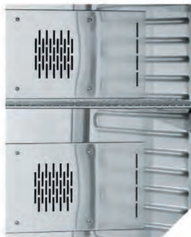
Blick in einen Memmert-Schrank: Peltier-Elemente sorgen im Innen- raum für perfektes Klima.
