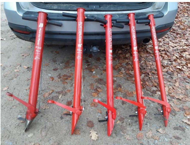
Bild 9: Pottiputki Pflanzrohr (unterschiedliche Durchmesser)
