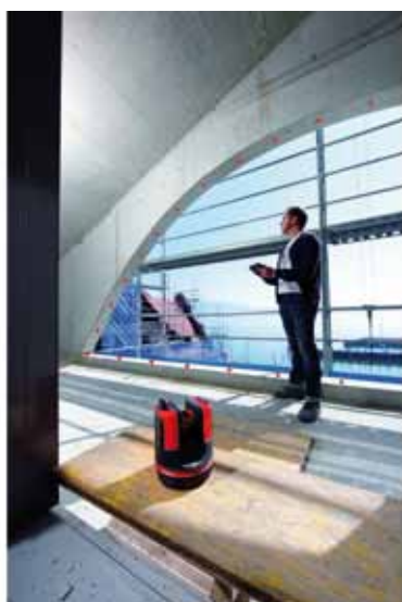
Bogenmessung mit dem 3D DISTO
