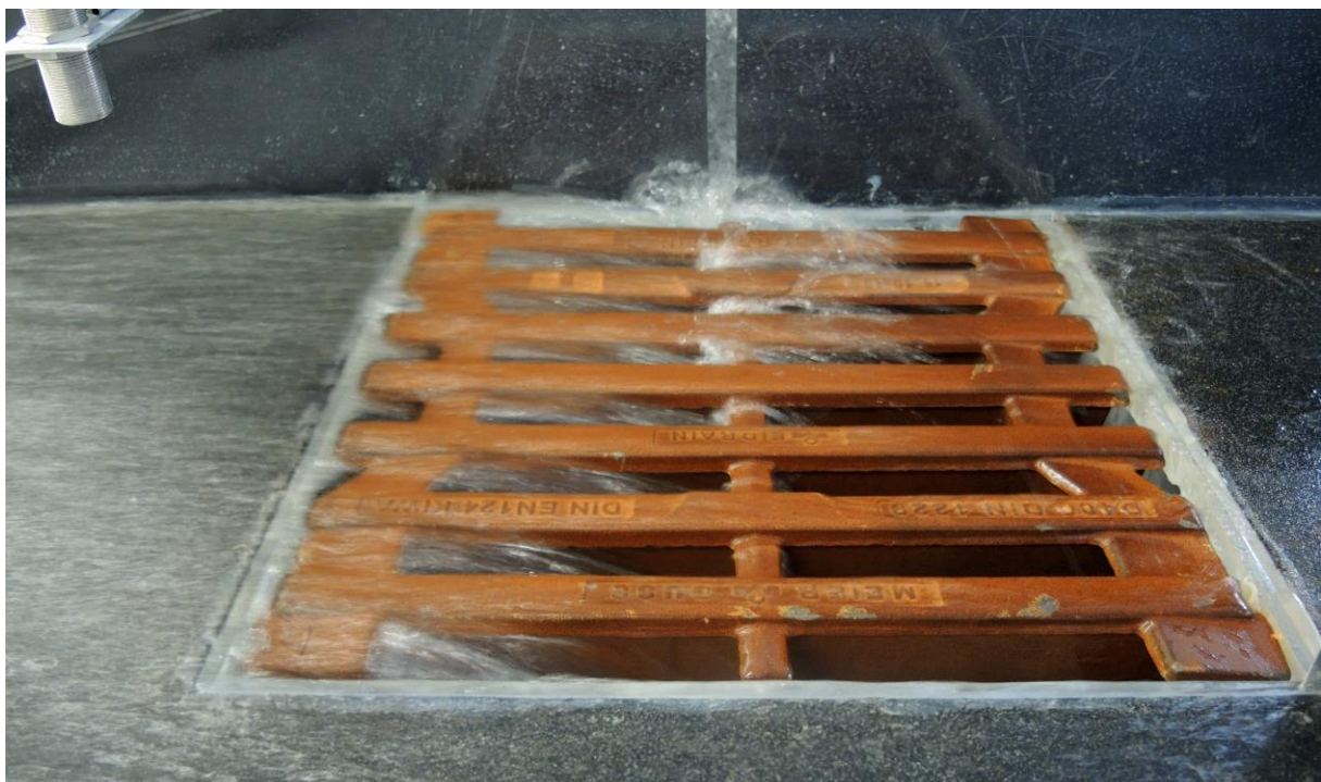
Abbildung 47: MEIDRAIN® (physikalisches Modell, S_L = 100 \% , Q = 12 \text{ l/s} )
