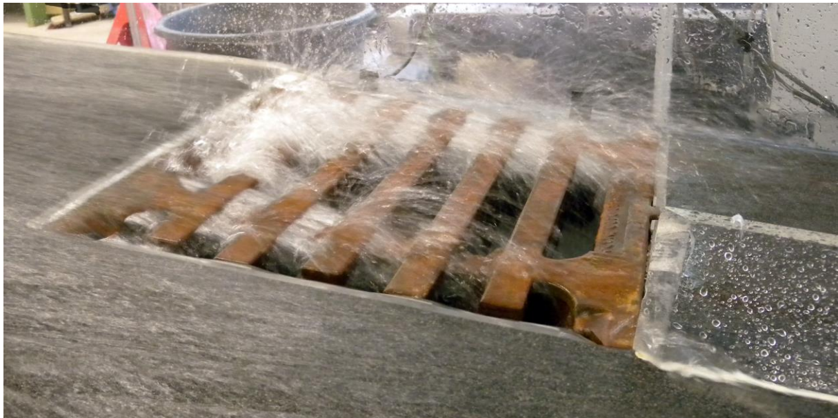
Abbildung 46: Standardaufsatz nach DIN 19583 (physikalisches Modell, S_L = 100 \% , Q = 12 \text{ l/s} )
