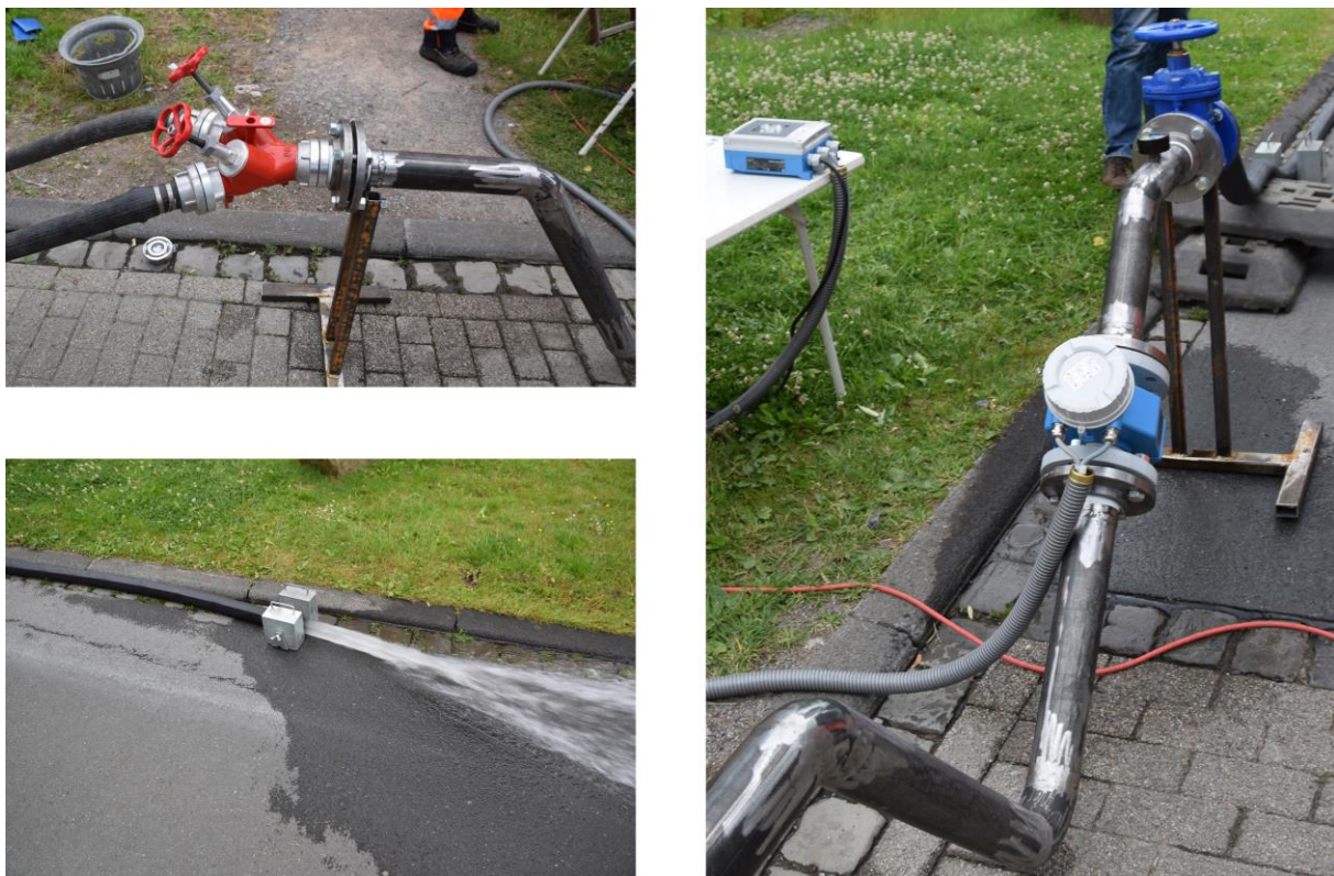
Abbildung 53: Messeinrichtung im Zulauf (Feldversuche)
