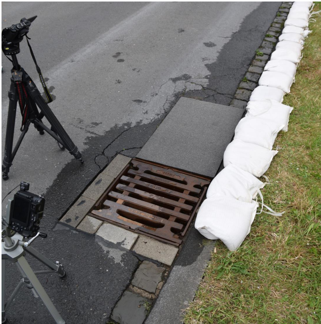
Abbildung 52: Versuchsaufbau Feldversuche, Aufsatz nach DIN 19583 500 x 500
