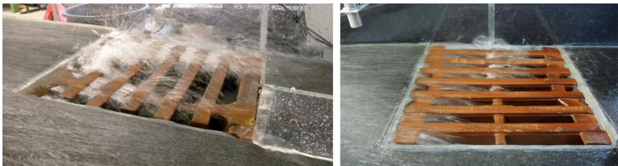
Abbildung 8: Physikalisches Modell, S_L = 100 \% , Q = 12 l/s, links: Standardaufsatz nach DIN 19583, rechts: MEIDRAIN ®
