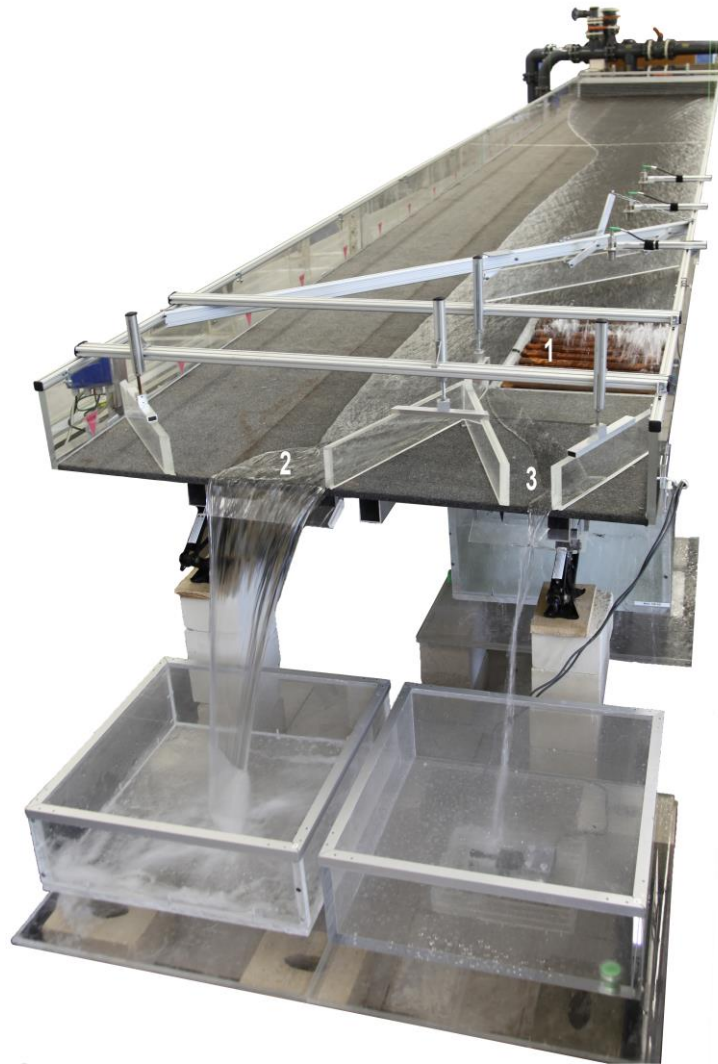
Abbildung 2: Physikalisches Modell im Wasserbaulabor der Uni Wuppertal
