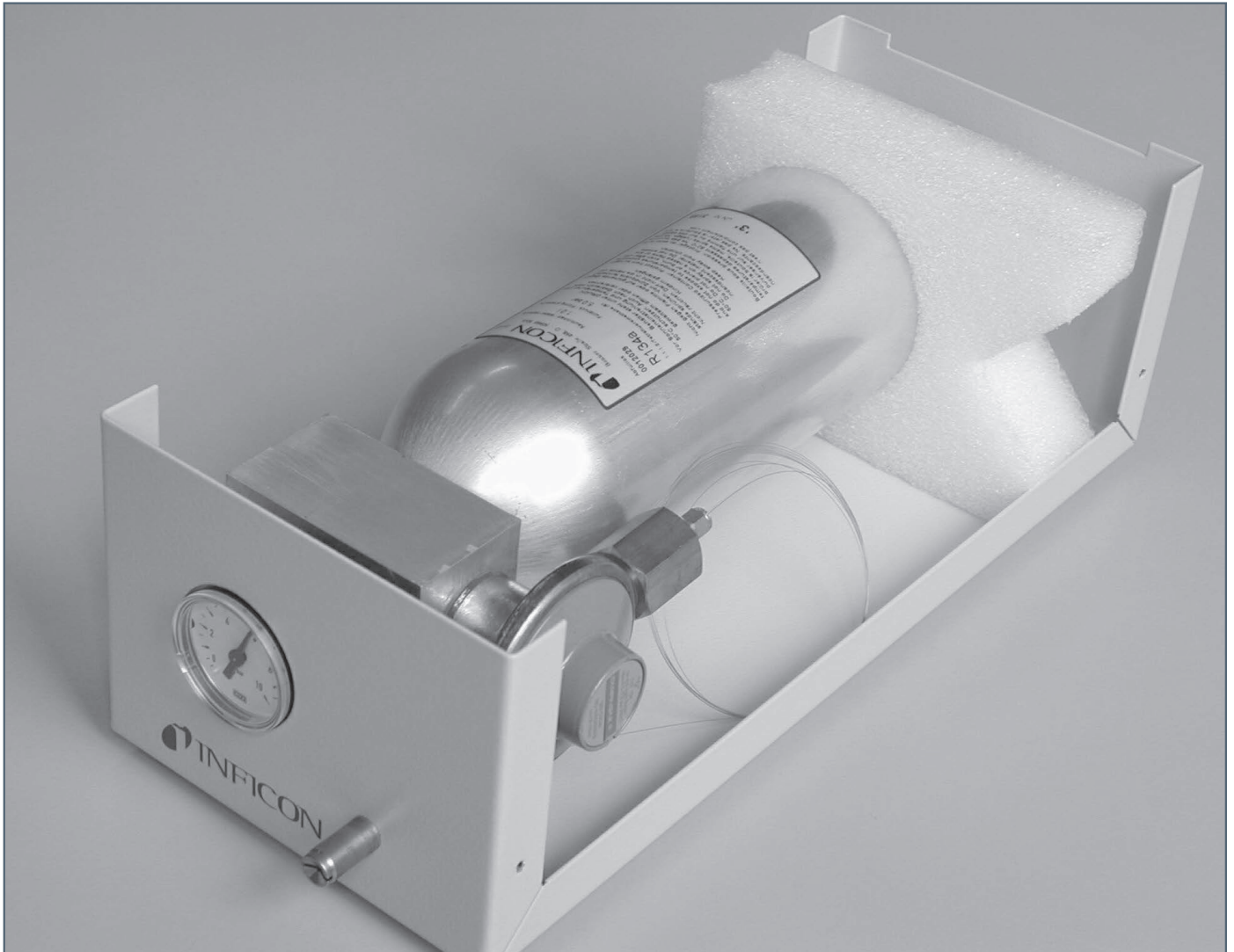
Abb. 11: Kalibrierleck für Schnüffel-Technik mit Druck-Regler
