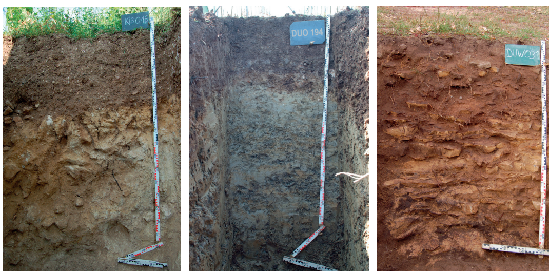
Abb. 3.4: Beispiele für typische Bodenformen im Untersuchungsgebiet. Links: Pararendzina-Rigosol aus Kalkstein (Tertiär) (KIB 015); Mitte: Rigolter Pelosol aus Tonmergel (Tertiär) (DUO 194); Rechts: Braunerde aus Sandstein (Buntsandstein) (DUW 031); Fotos: U. Dehner und S. Sauer.
