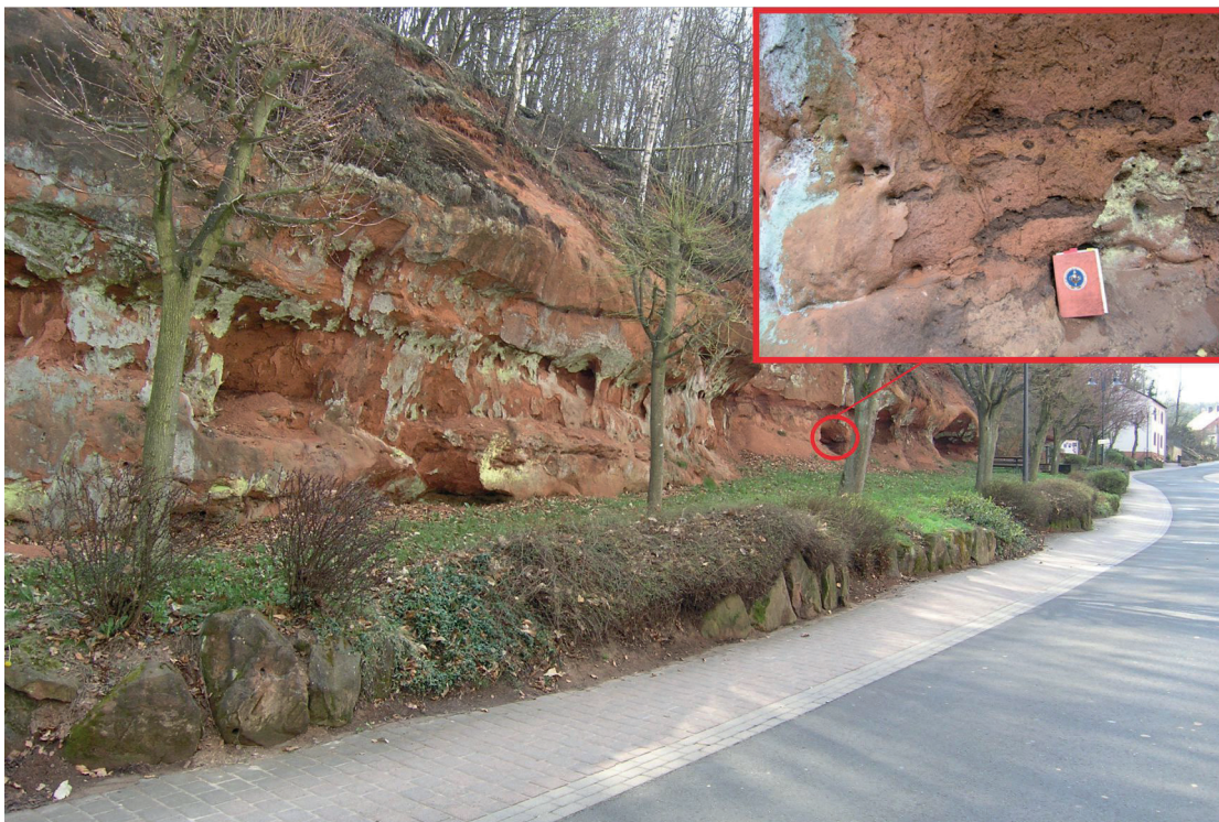
Abb. 4.6: Karbonatfreie Fein- bis Mittelsandsteine der Stauf-Schichten („Formsand“); Aufschluss an der Ortsdurchfahrt Sippersfeld. Detailausschnitt aus einem Bereich mit großen Nestern aus Eisen-/ Mangan-Mulm (braun) innerhalb der Formsande (Foto: F. Bitzer).
