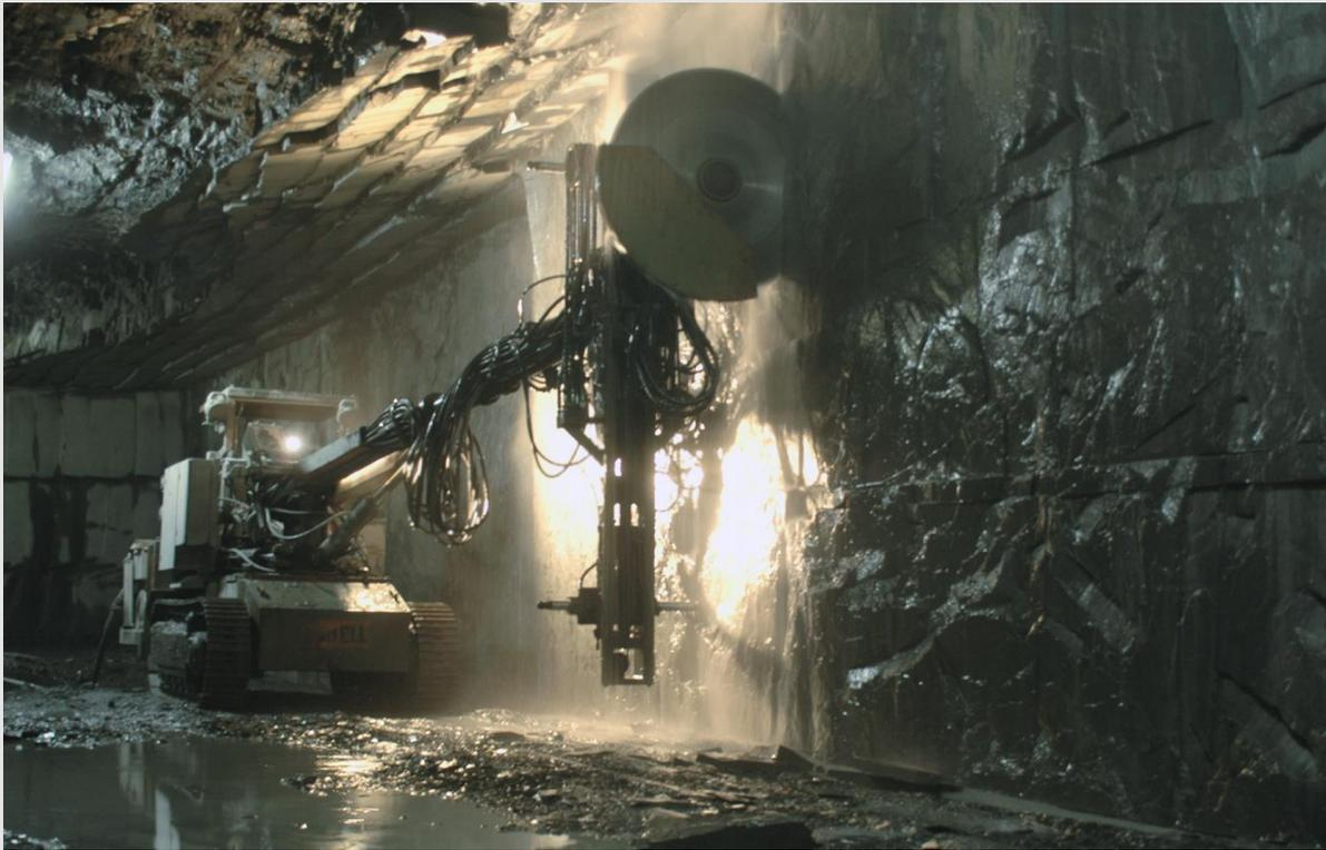
Abbildung 20: Abbau von Dachschiefer untertage im Bergwerk bei Mayen (Foto: LGB 2011).
