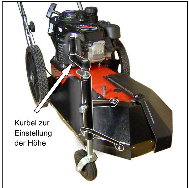
Der Stützrad-Rahmen wird an vorhandenen Punkten befestigt. Oben und vorn unten werden Schrauben ausgetauscht und hinten unten wird **diese** Strebe eingebaut.
