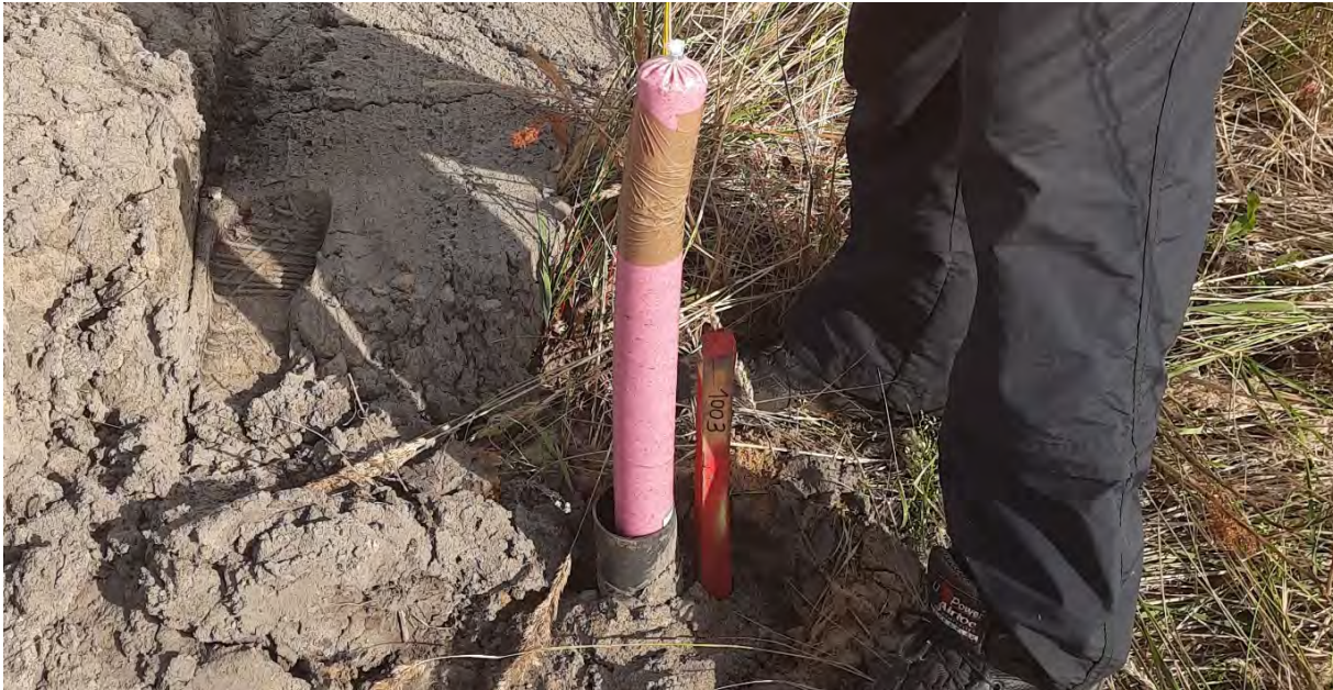
Abbildung 9: Patrone mit d = 50 \text{ mm} in Verrohrung mit ID = 65 \text{ mm}
