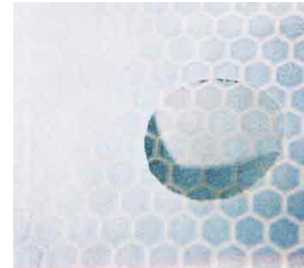
Lichtbrechung durch Wasserfilm - Reflexfolie
