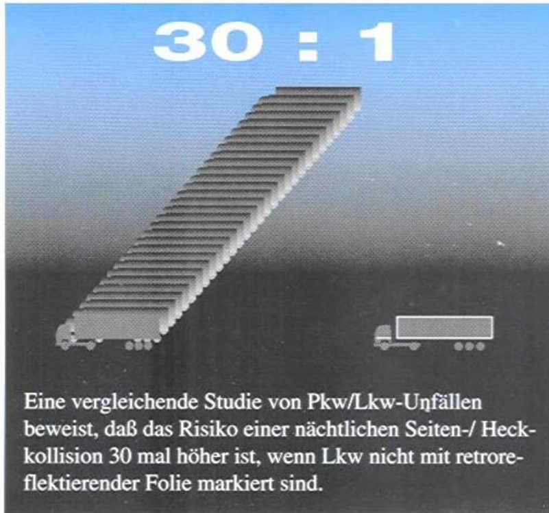
Kennzeichnung durch Konturmarkierung als Vorschlag zur Verbesserung der seitlichen Kenntlichmachung.
