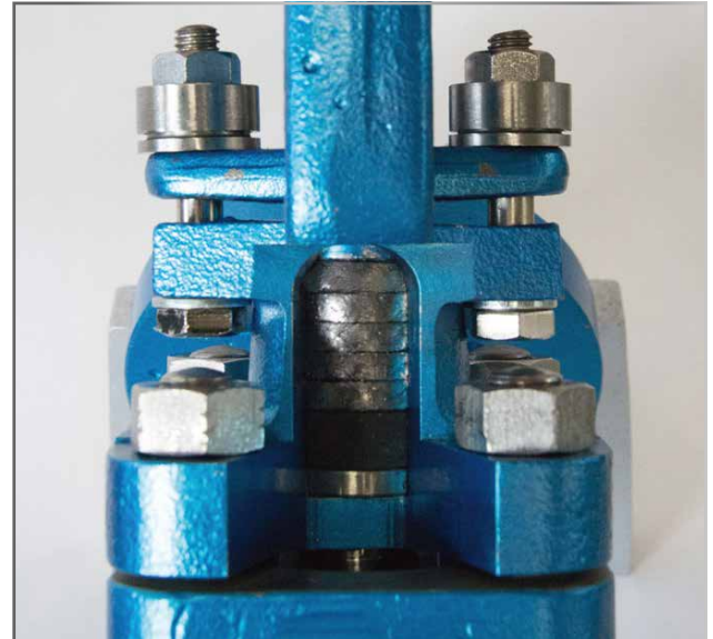
Optimierte Armaturenabdichtung mit Kohlebuchse, Abstreifring und Vorlagerung
