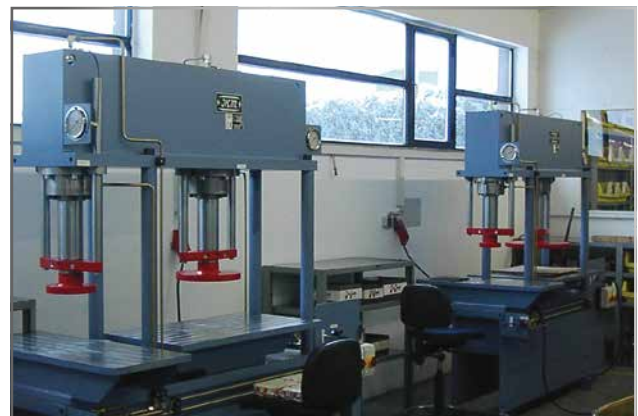
Spezielle, langsam laufende hydraulische Pressen
