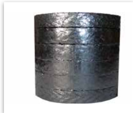
Ringsatz 6655 Für Regel- und Absperrventile bis 600°C im Einsatz bei Dampf. Alle Ringe dieses Satzes werden mit Schrägschnitt ausgeführt.
