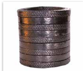
Rußbläser Ringsatz Für Rußbläser bis 400°C im Einsatz bei Dampf. Aufgebaut aus mehrlagig geschichteten Abstreif- und Extrusionsschutzringen, verbunden mit speziellen Ringen aus flexiblem, expandierten Graphit. Alle Ringe werden im Standard mit Stumpschnitt ausgeführt. Die beste Funktion erreicht man in Verbindung mit LiveLoading (Seite 20). Spezielle Ausführung mit weicher Federkraft und langem Federweg L10RB, L12RB oder L3/8RB, L1/2RB. Für optimale Standzeiten wird der Einsatz einer passenden Bronzelagerbuchse im Stopfbuchsraum empfohlen, damit die Rußbläserlanze auf die Packung keine einseitige, radiale Belastung ausübt.
