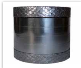
Ringsatz 6660 Für Armaturen bis 650°C im Einsatz bei Dampf. Der Satz zeichnet sich durch minimalen Volumenverlust aus. Die Ringe der Dichtzone werden im Standard ungeteilt, oder auf Wunsch geteilt in 2 Halbschalen oder mit einem Schrägschnitt geliefert. Der Grund- und Deckring wird mit Schrägschnitt ausgeführt.
